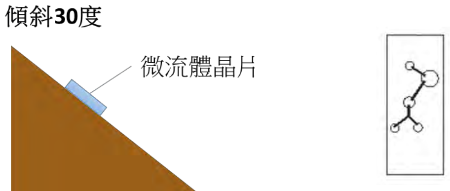
(圖 4) 多程序實驗傾斜方式的第 2 步驟(右圖為晶片方向)
