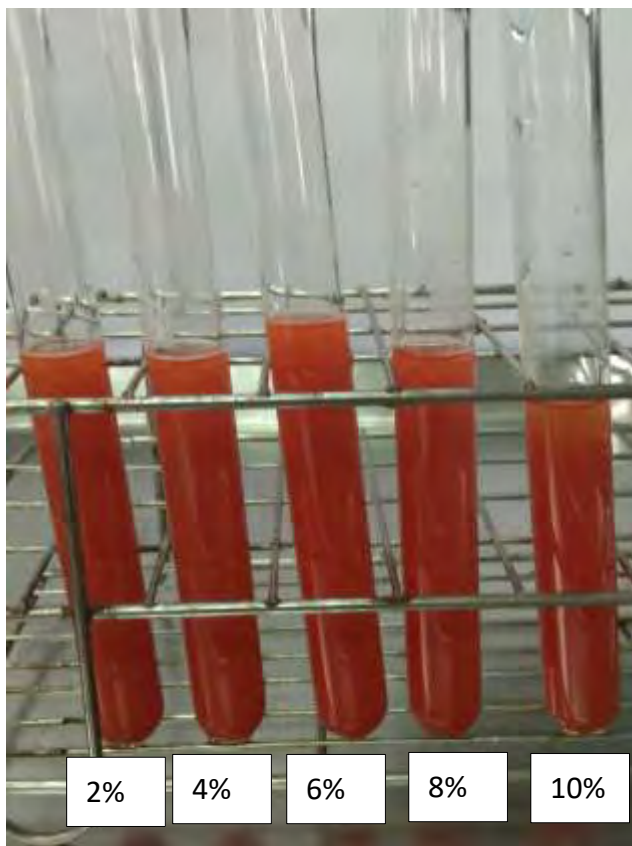
(圖 5)不同濃度的葡萄糖液在試管內加熱到紅色的照片
