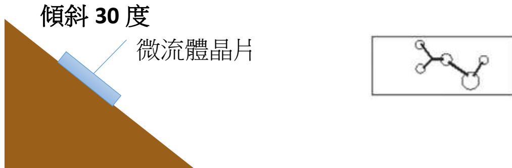
(圖 3) 單程序實驗傾斜方式+多程序實驗傾斜方式的第一步驟(右圖為晶片方向)
