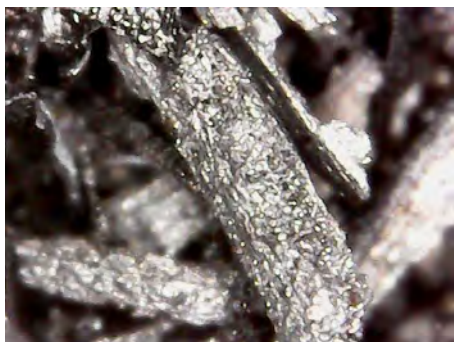
【圖 101】以顯微鏡觀察筍殼碳表面結構
