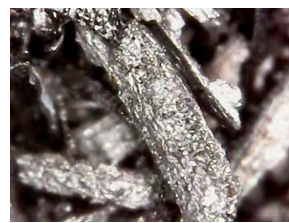
圖101 以顯微鏡觀察筍殼碳表面結構
