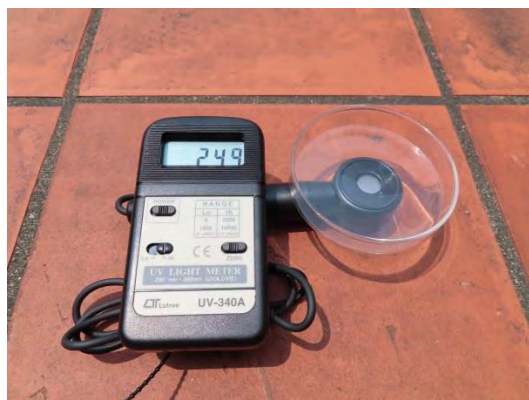
圖 29 培養皿遮蔽時紫外線強度:2490 \mu\text{W}/\text{cm}^2
