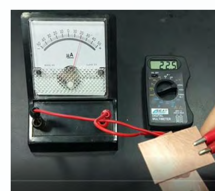
圖20 單層電壓及電流測量
