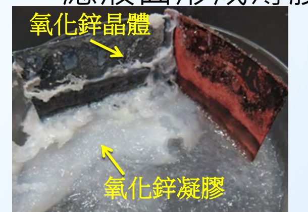
圖28 氧化鋅凝膠與氧化鋅晶體
