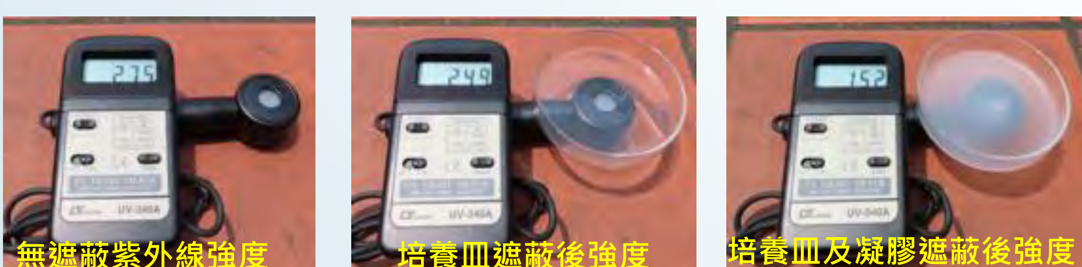
圖22 使用紫外線強度計測量凝膠對紫外線的遮蔽效果
