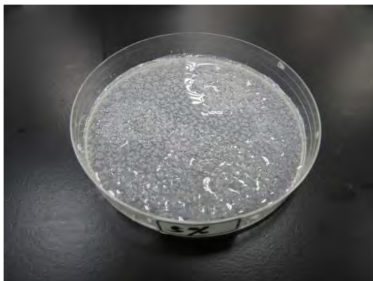
圖23 氧化鋅凝膠的吸水情形
