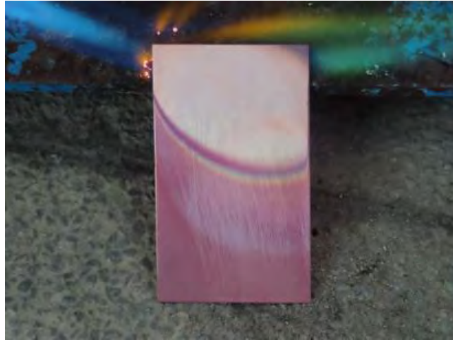
圖9 使用噴火槍加熱銅片表面之情形
