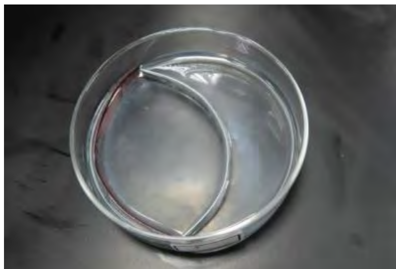
圖19 彎曲的鋅片及表面氧化銅片反應1週後之情形
