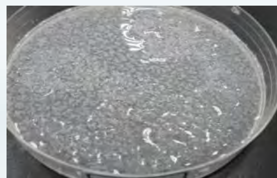
圖17 氧化鋅凝膠吸水情形
