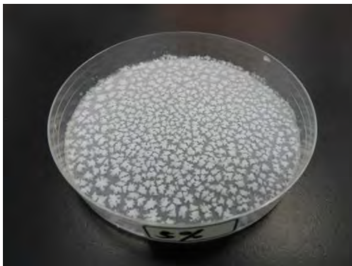
圖22 於培養皿中乾燥的氧化鋅凝膠
