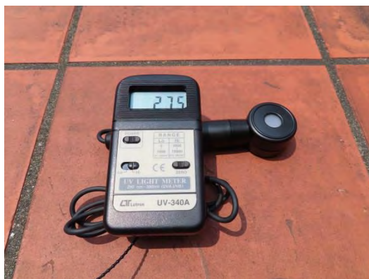
圖 28 無遮蔽時紫外線強度:2750 \mu\text{W}/\text{cm}^2
