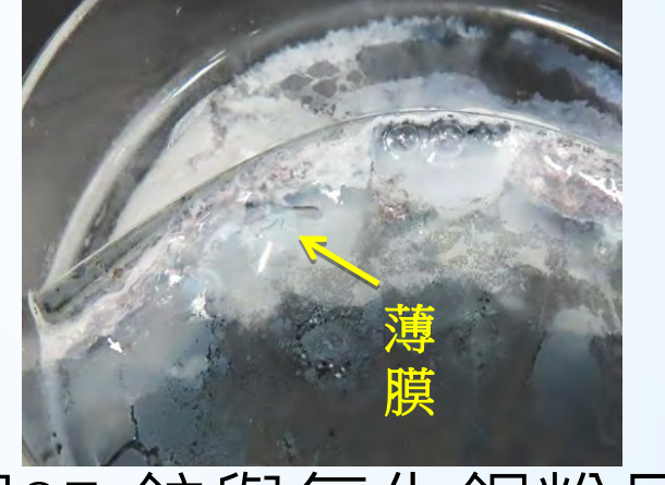
圖27 鋅與氧化銅粉反應液面形成薄膜
