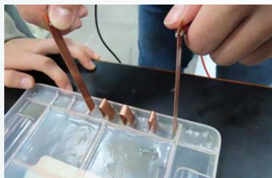
圖18 測量四組氧化鋅凝膠發電電壓
