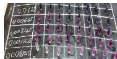
▲圖 25：將結冰的各吸管組截斷後裝入塑膠比色槽中
