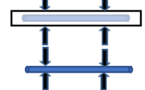
▲圖 23：水平擺放全包組(上)及包下組(下)結冰方向示意圖
