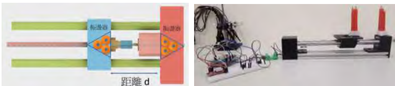
圖二：(a) 實驗概念圖與(b)步進馬達與一長 30 公分的 2040 鋁擠條組成之線性滑軌。
