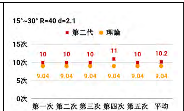
圖 22：當擺長 R 為 40 cm、單擺由 15^\circ 擺至 30^\circ ，測量拉放線長度 d 為 2.1 cm 時，所需的拉放線次數 N 。
