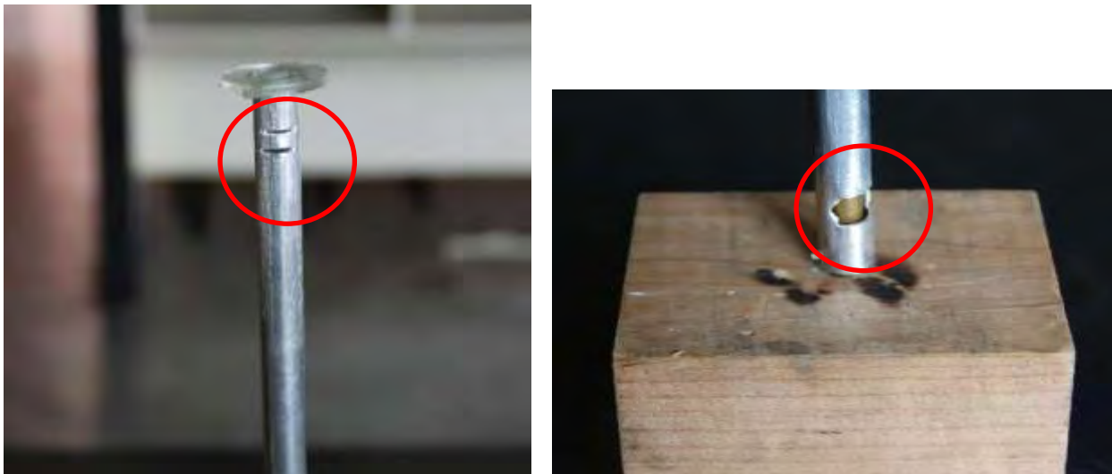
圖二十四 金屬棒挖洞(紅色圈圈為挖洞的部分)
