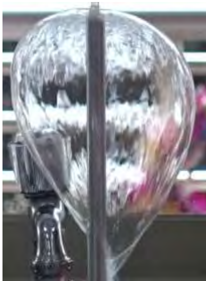
圖二十二 h5(31公分)的水鐘(洗碗精溶液)截圖
