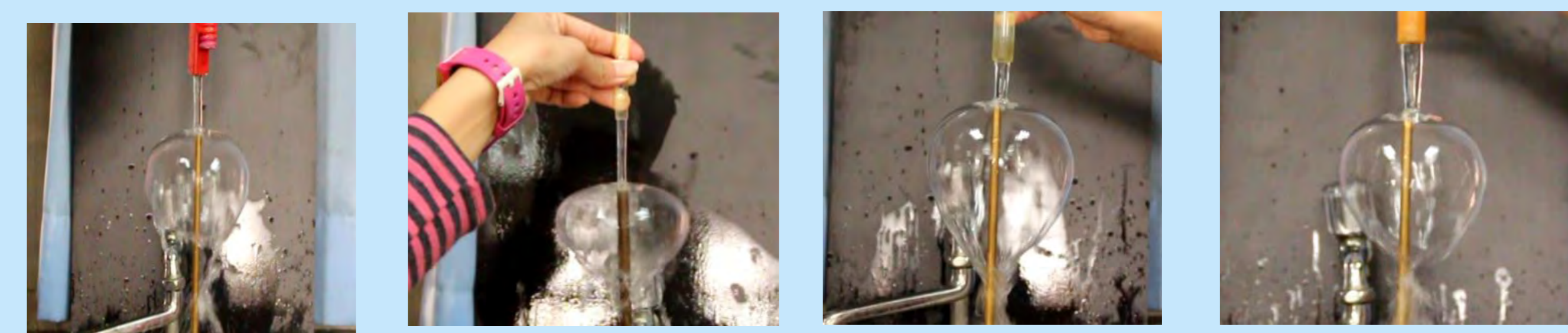
圖 不同水管粗細時的水鐘截面(水管內直徑 0.62 cm、1.01 cm、1.29 cm、1.81 cm)
