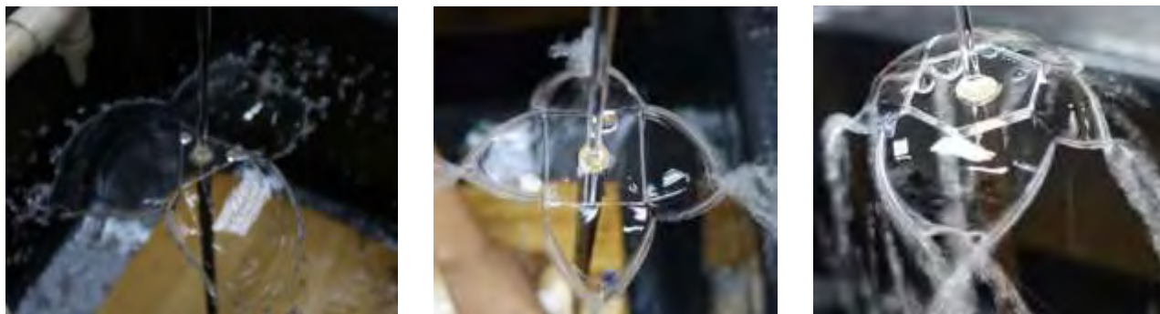
圖四十六 不同形狀擋水片在適當出水口高度下，都出現水花瓣形狀
