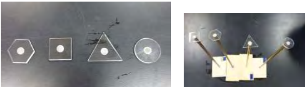
圖十一 不同形狀的擋水片及實驗裝置
