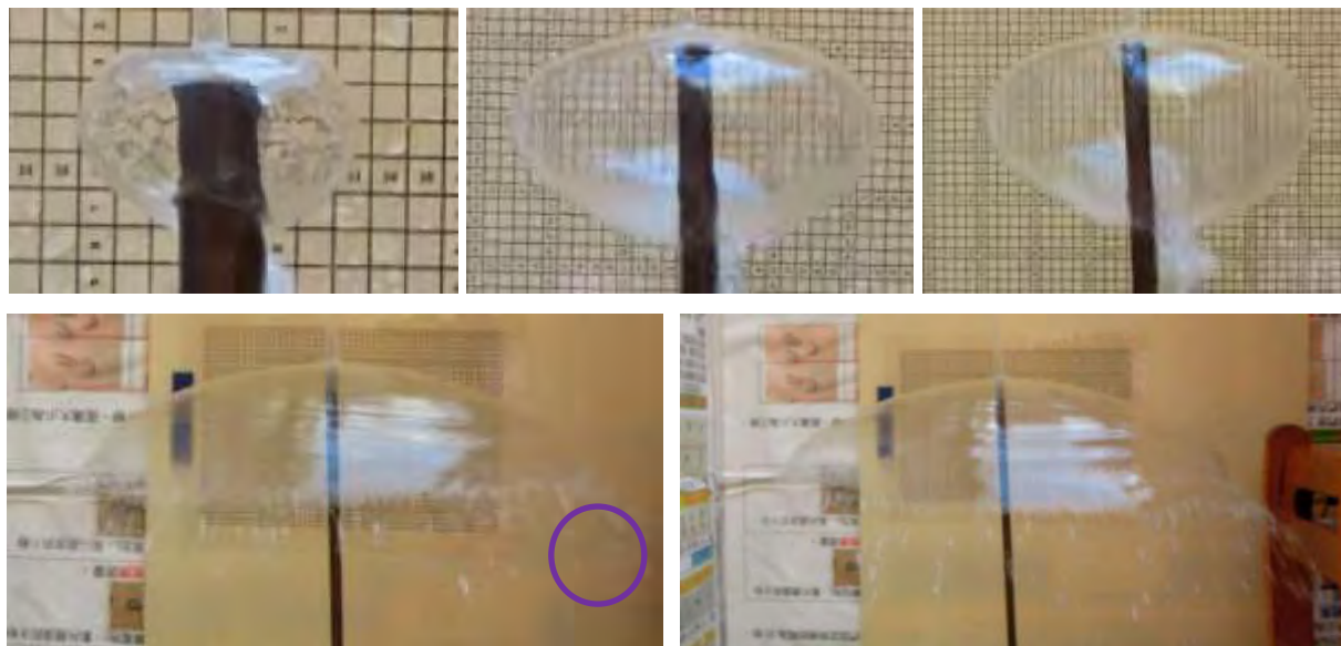
圖三十八 不同水龍頭角度時的水鐘截圖(左上到右下為角度 1~5)(紫色圈圈為出現小水滴處) (出水量由左上到右下，分別為 40.0、58.0、74.7、93.9 及 111.3 ml/s)
