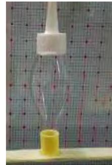
由以上實驗數據推測因為上方泡膜壓力較小，氣體由下往上流動。
