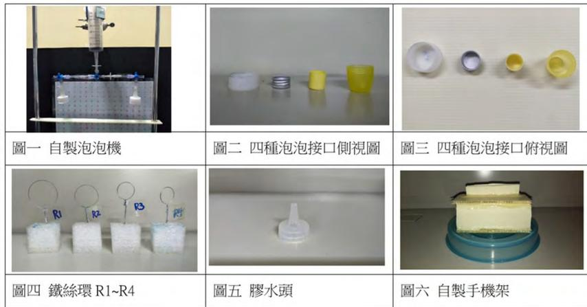
為了進行本次實驗，我們自製泡泡機（如圖一），上方支架固定的針筒，方便我們定量泡泡內的氣體體積量，吹泡泡的地方以三通管和塑膠管連接，下方放置可活動的瓦楞板，方便我們放置接口和進行下拉的實驗，後面放了一張格子紙方便測量。
