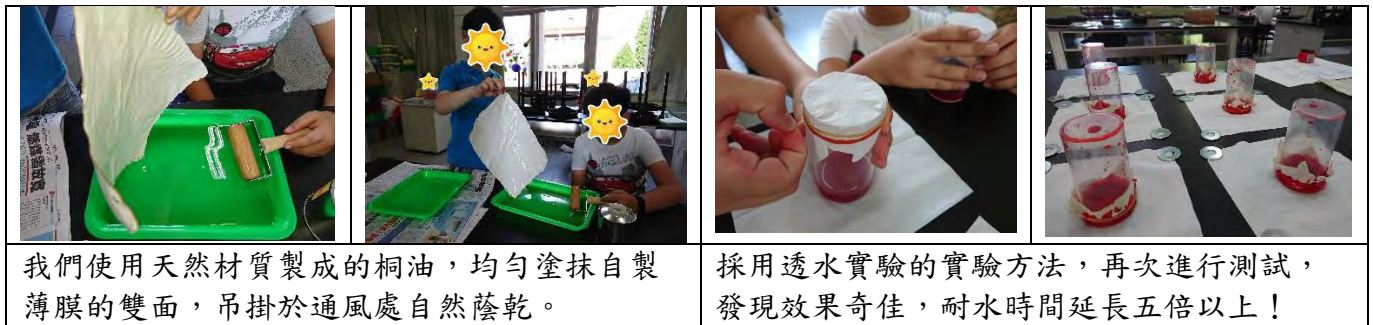
18-1 添加桐油後的透水實驗操作圖
