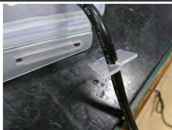
電線要塞在切開來這片塑膠中間的洞。
