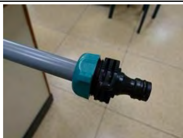
排水管加裝快速接頭。
