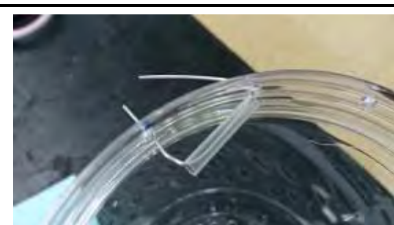
穿進罐子開口的小洞，用尖嘴鉗拉緊。
