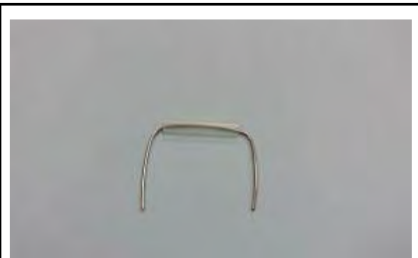
把鐵絲套上吸管當做轉軸，再彎成U字型。
