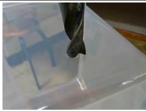
在密封箱側面鑽出一個排水孔。
