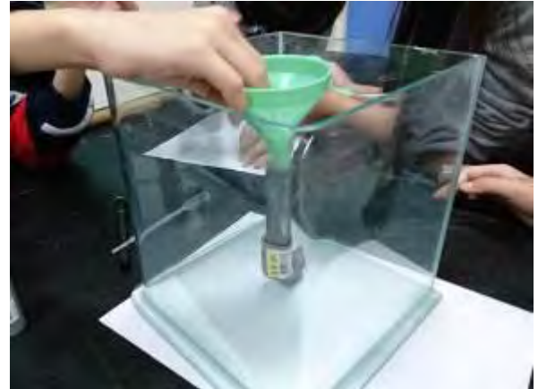
組裝漏斗進水口。
