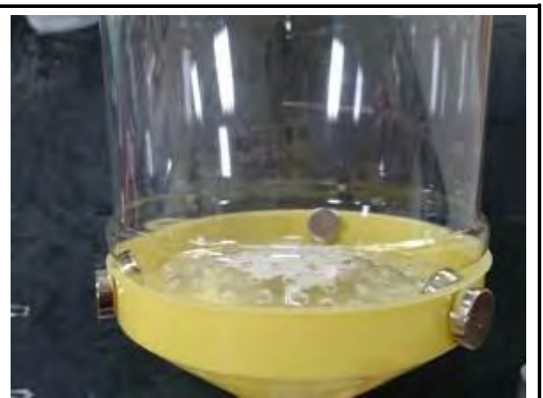
罐子跟漏斗用磁鐵相吸固定，比較方便拆下來收垃圾。
