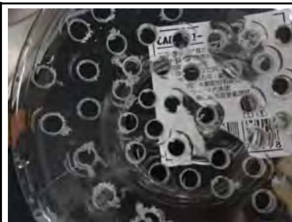
罐子底部鑽洞直接當成過濾的地方。
