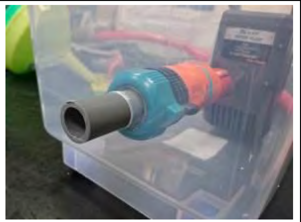
把馬達的出水管黏在排水孔上，讓箱子回復再變成密封的情形。
