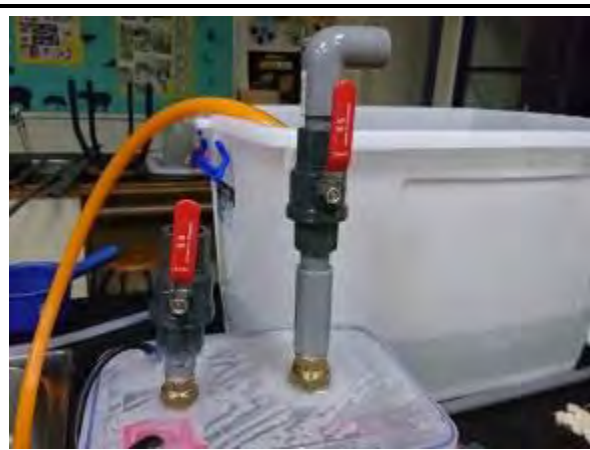
加水口裝開關，確定抽水時箱子是密封的。 漏斗進水口裝開關，防止虹吸水倒流。
