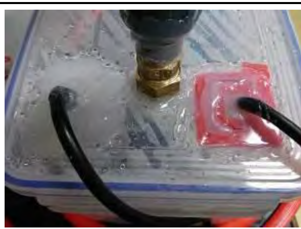
蓋子挖兩個孔洞，插頭穿過去後再把它黏回去，讓箱子變成密封。
