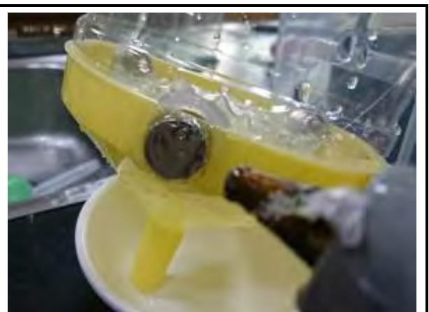
用熱熔膠把漏斗外的磁鐵黏住包起來。
