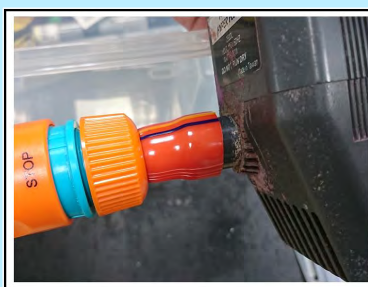
沉水馬達排水口加裝快速接頭。
