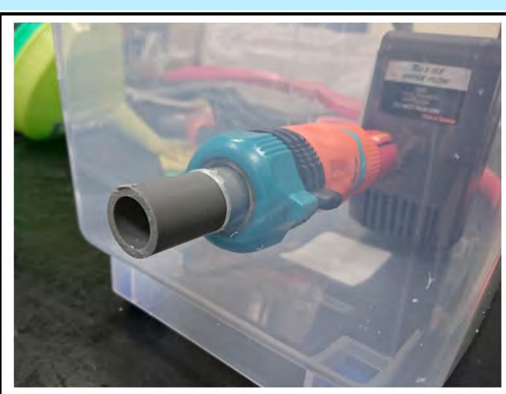
把馬達的出水管黏在排水孔上，讓箱子回復再變成密封的情形。
