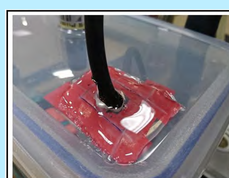
把密封箱的蓋子切開一塊，讓沉水馬達插頭電線可以穿過去。
