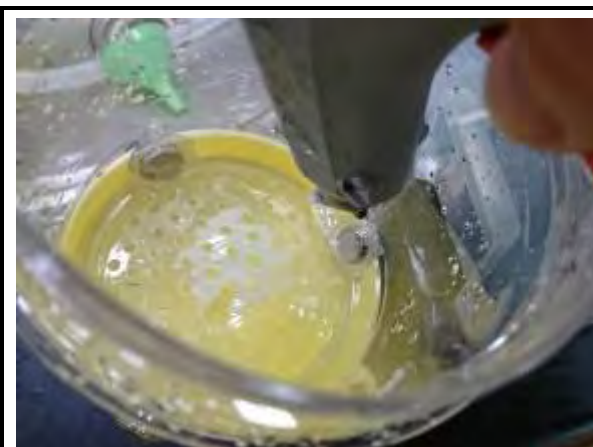
用熱熔膠把罐子裡面的磁鐵黏住包起來。
