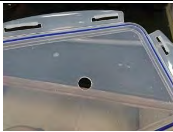
把密封箱的蓋子中間鑽洞，準備要塞漏斗進水管。
