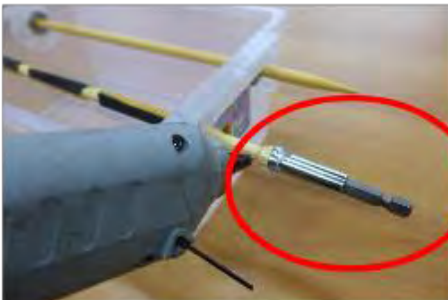
在木棍上加裝六角連接器
