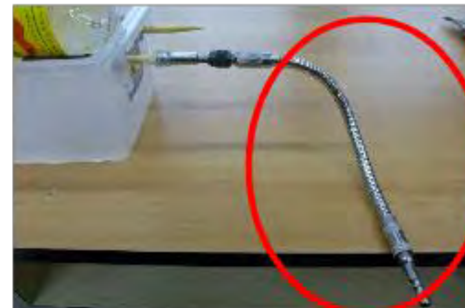
六角連接器上加上電鑽彎管
