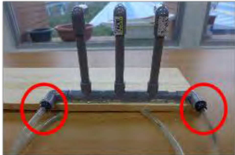
左右各設計一個入水口增強水量與水壓
