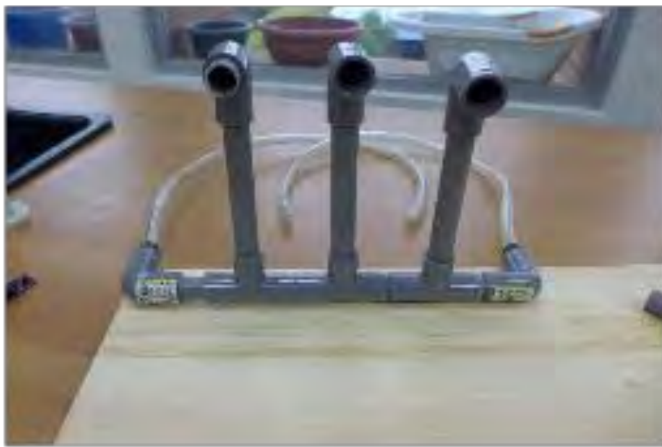
利用 PVC 水管組裝流水裝置
