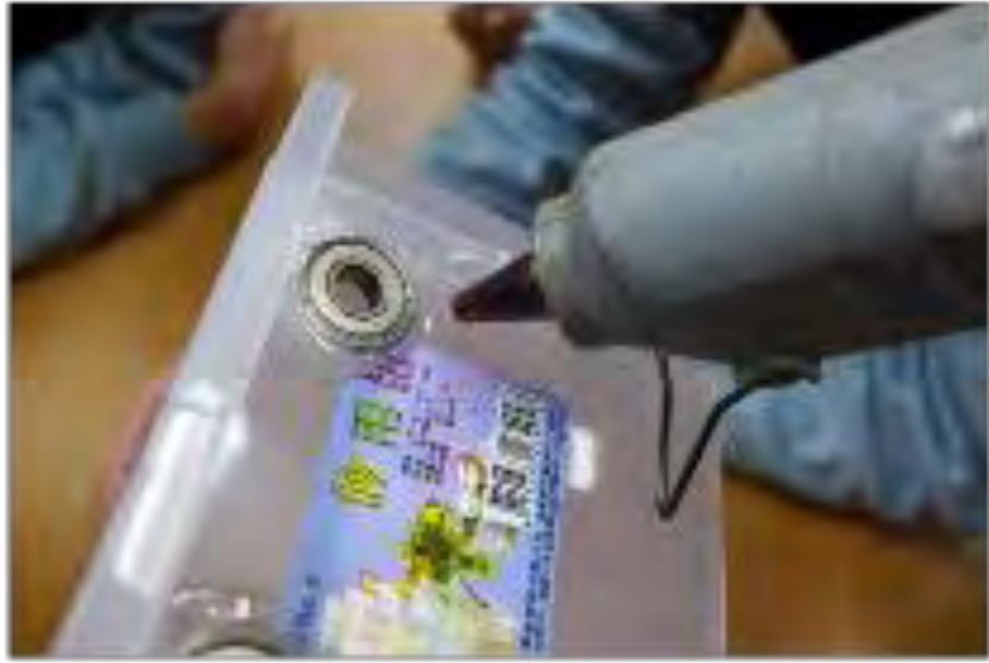
將培林安裝進去並用熱熔膠固定
