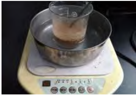
圖 1 混合材料隔水加熱
