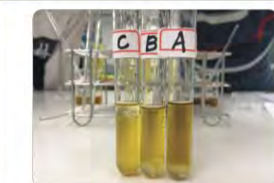
【油溶性實驗】 先觀察沙拉油的分層情形後再搖勻觀察溶油情形
