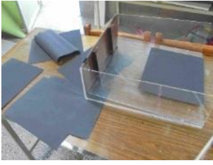
圖 4：測試不同砂紙粗糙度，決定使用 280cw
