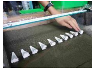
圖 52：六爪消波塊的消波能力更佳。
