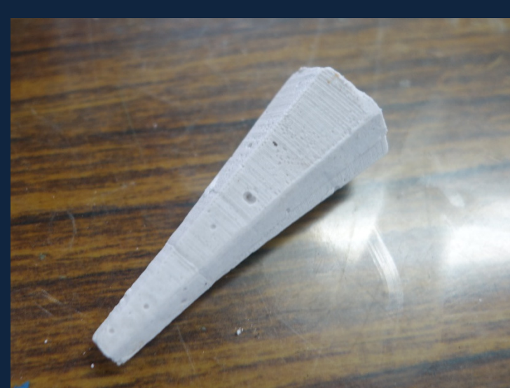
圖17：石膏翻模後的六角錐台體自製消波塊。
