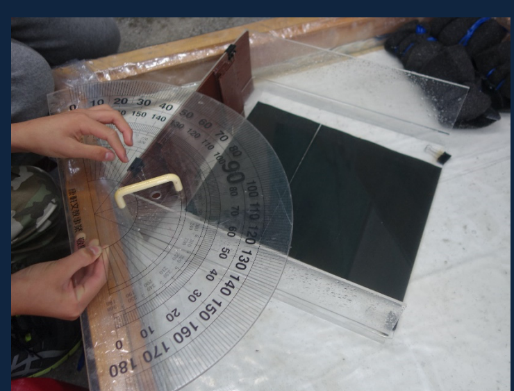
圖14：改變模擬沙灘箱的放置角度，測試角錐！
