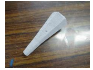
圖 40：討論最佳比例時，拿之前實驗的 3D 列印模型做比較。 圖 41：利用排水法測出消波塊模型的體積。以便計算自製消波塊大小 圖 42：讓自製消波塊重量與市售消波塊相似，兩者差 0.08 克。 圖 43：石膏翻模後的六角錐台體自製消波塊。
