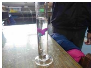
圖 40：討論最佳比例時，拿之前實驗的 3D 列印模型做比較。 圖 41：利用排水法測出消波塊模型的體積。以便計算自製消波塊大小 圖 42：讓自製消波塊重量與市售消波塊相似，兩者差 0.08 克。 圖 43：石膏翻模後的六角錐台體自製消波塊。
