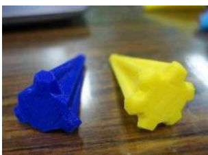
圖 49：左邊三爪無法轉動定向，最後採用右邊六爪形狀。
