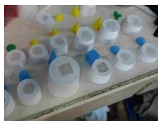
圖 20：將各種幾何模型以矽膠模以石膏進行翻模
