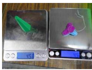
圖 40：討論最佳比例時，拿之前實驗的 3D 列印模型做比較。 圖 41：利用排水法測出消波塊模型的體積。以便計算自製消波塊大小 圖 42：讓自製消波塊重量與市售消波塊相似，兩者差 0.08 克。 圖 43：石膏翻模後的六角錐台體自製消波塊。
