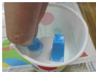
圖 17：以矽膠製模 3D 列印幾何模型。
