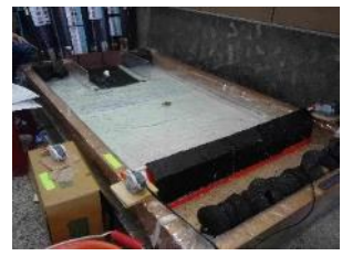
圖 34：以起波器進行測試的底直徑 5cm 圓錐
