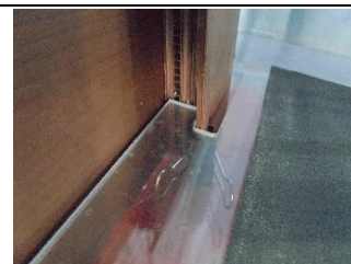
壓克力板下方使用長尾夾協助固定高度。
