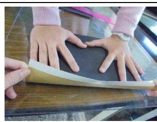
將挑選的 280 cw 砂紙黏在壓克力板上
