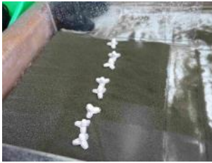
圖 44：測試一排市售消波塊的護沙效果。
