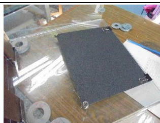
在壓克力斜坡板上以鉤磁鐵固定砂紙測試
