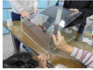
圖 5：使用高度固定斜坡角度，準確度高。
