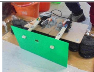
往前推動起波器，履帶無法回到原來位置
