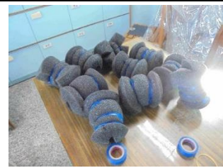
經過測試，海綿捆成筒狀消波效果較好。
