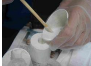
圖 29：調配石膏倒入矽膠模中進行翻模。
