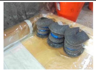
完成的筒狀消波海綿排在水槽兩側消波。
