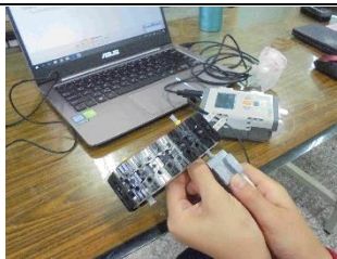
使用電子樂高的履帶製作往前推動起波器
