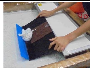
加重物的扇葉拍打水面製波，沒有波浪。
