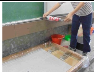
嘗試重物掉落至水中製波，波浪不穩定。
