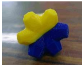
圖 50：底部融合市售消波塊形狀，設計成六爪
