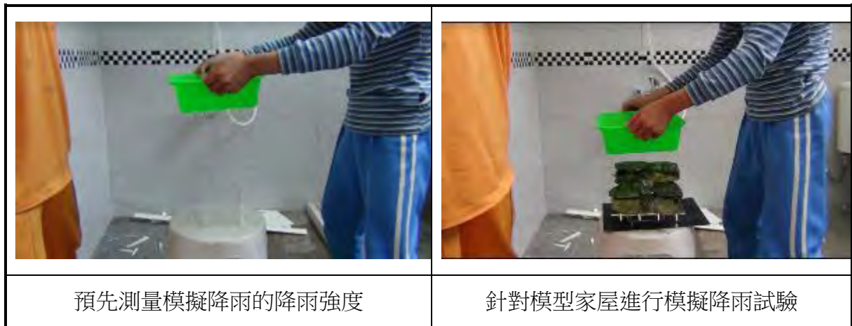
圖 7 屋頂防水試驗情形
