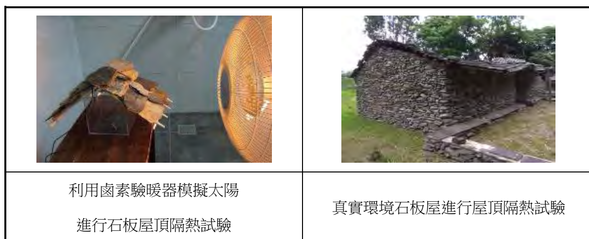
圖 8 外殼隔熱試驗試驗情形
