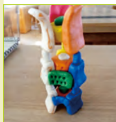
三層三腳鼎塊的油土模擬模型。
