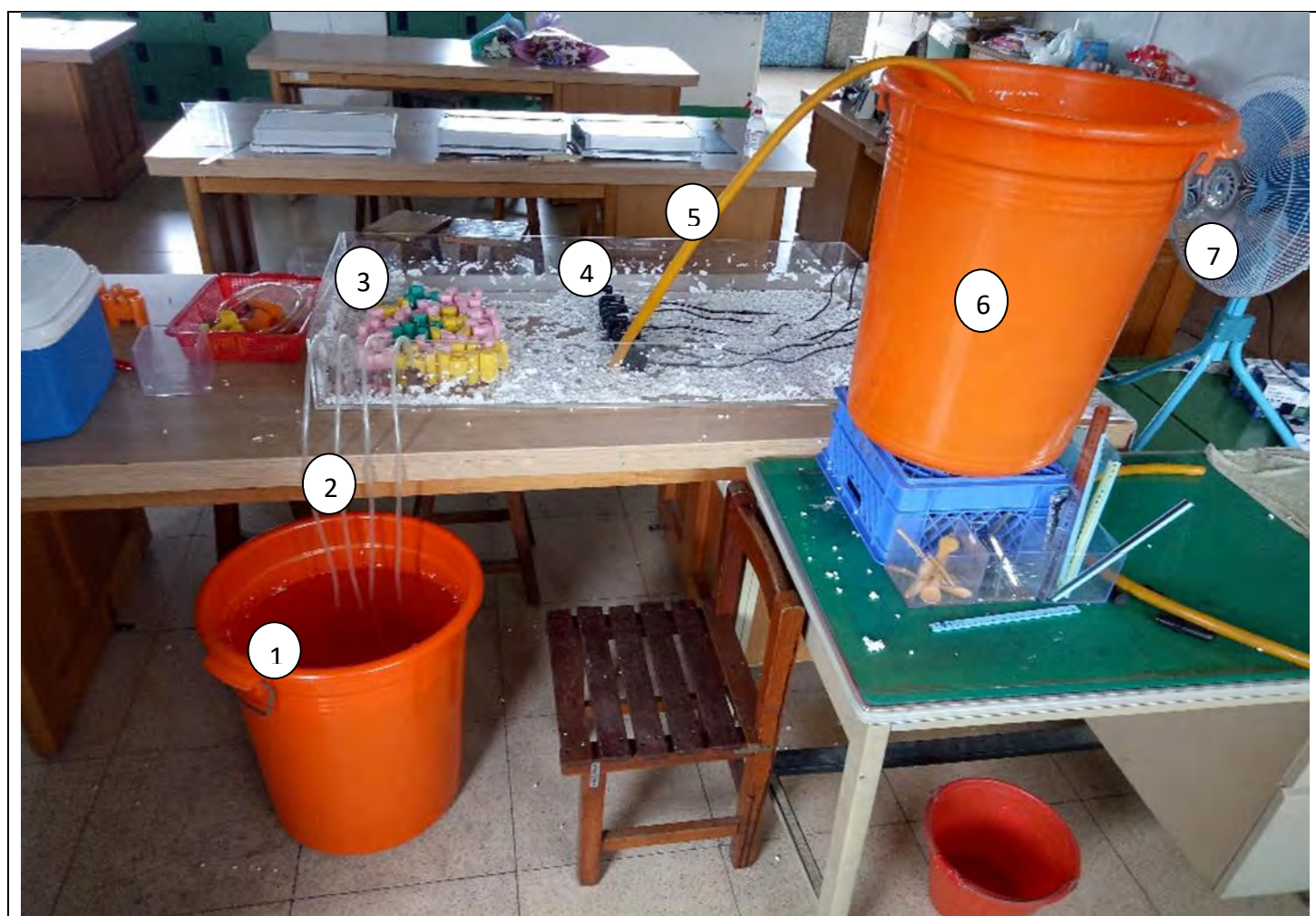
①退潮水桶*1②退潮水管*4③消波塊*20④造波馬達*5⑤漲潮水管*1⑥漲潮水桶*1⑦造風工業電風扇*1
