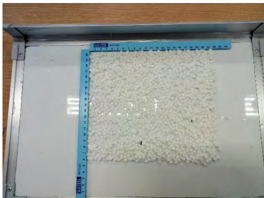
將白板當基底，使用磁鐵尺排成直角，將保麗龍顆粒均勻鋪平成一個四邊形。
