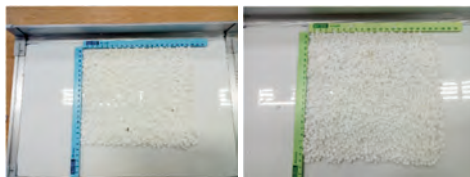
將白板當基底， 使用磁鐵尺排成 直角，將保麗龍 顆粒均勻鋪平成 一個四邊形。
