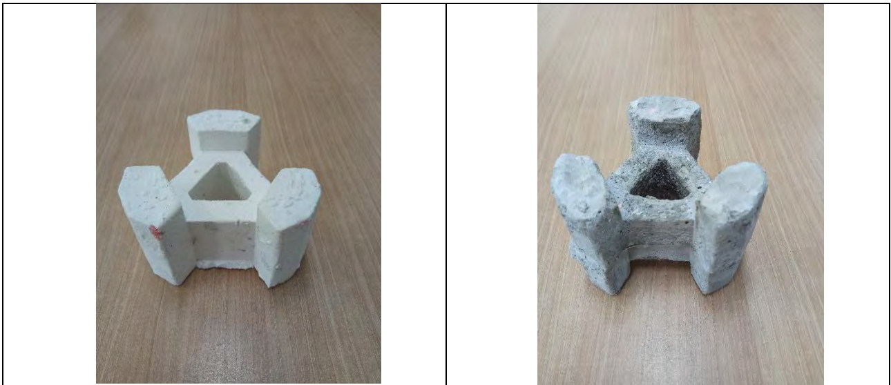
耗時費工的石膏(左)與水泥(右)成品，品質頗為粗糙，重量不均勻。
