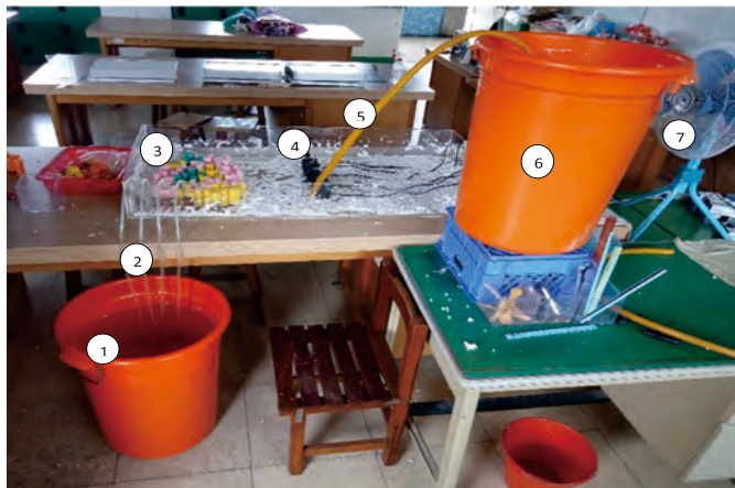
①退潮水桶*1②退潮水管*4③消波塊*20④造波馬達*5 ⑤漲潮水管*1⑥漲潮水桶*1⑦造風工業電風扇*1
