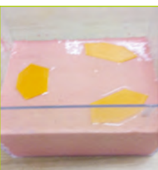
調和印模粉將母模置入膠狀印模粉等其凝固。
