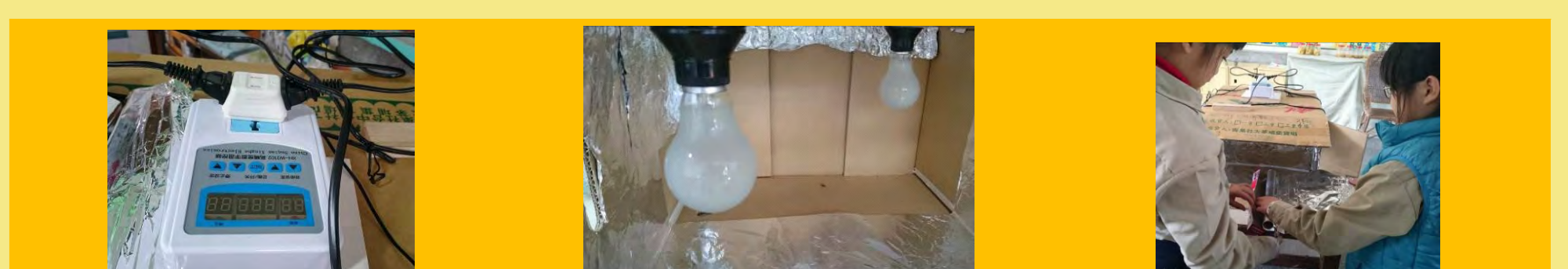
溫度控制器 | 箱子較大所以我們在前後裝設各一顆60W燈泡 | 箱子內部周圍張貼反光的錫箔紙，希望週邊的熱源能經由光的反射而達到熱均勻
