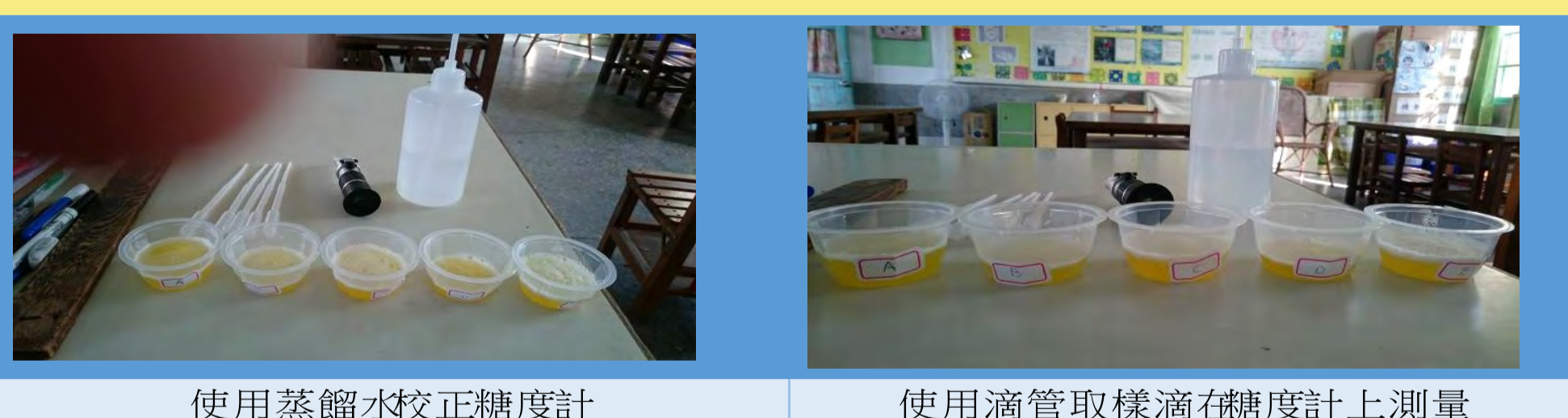
使用蒸餾水校正糖度計 | 使用滴管取樣滴在糖度計上測量
