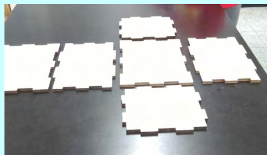
圖 2. 利用雷射切割將木箱零件切割出來
