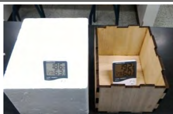
圖 1-1-2 將電子溫度計放入兩個箱體內偵測溫度。
