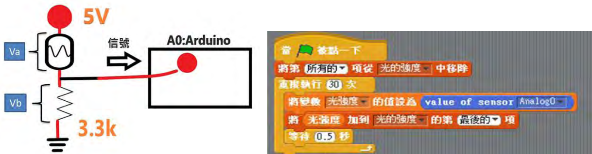
圖 3 (左) 光訊號偵測電路設計示意圖 (右) 偵測光訊號之程式
