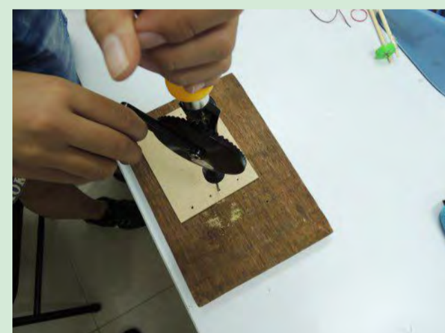
(圖40)利用手工鑽穿孔
