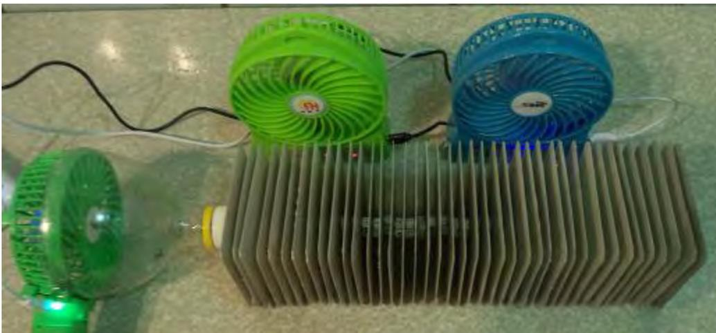
圖 31：「以鋁片增加表面積並噴霧狀水」散熱裝置
