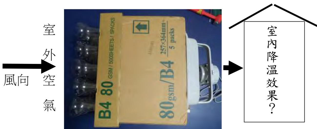
圖 20：「風由室內吸氣進入屋內」之窮人冷氣模擬實驗
