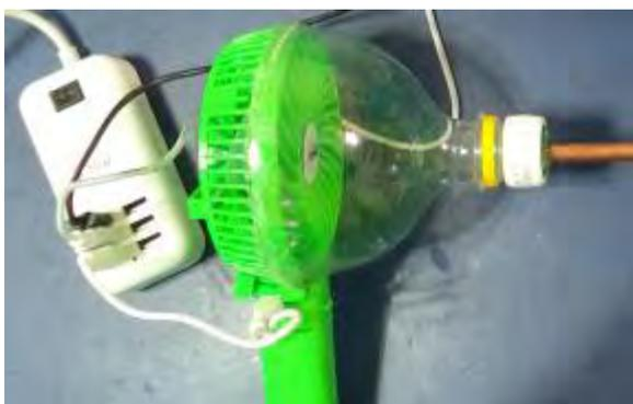
圖 25：可調轉速鋰電池強力風扇
