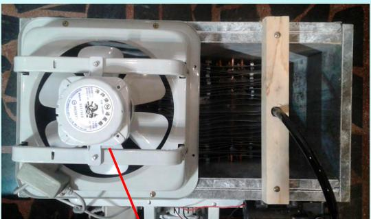
水蒸氣抽出風扇，增加蒸發速率
