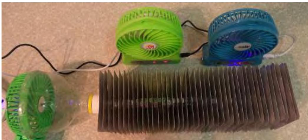
圖 40：「鋁片表面磨成霧面」散熱裝置
