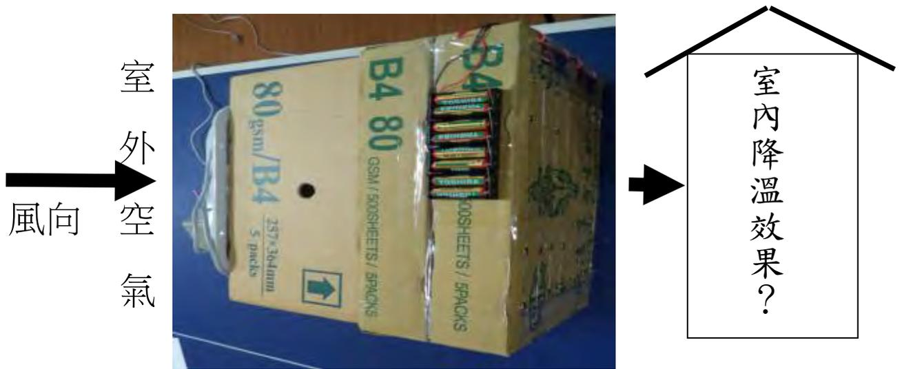
圖 21：以鋁片代替寶特瓶的「風從室外吹入屋內」之降溫實驗
