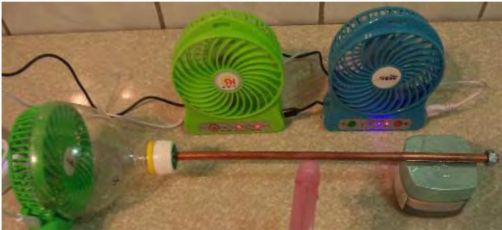
圖 30：「銅管表面噴霧狀水」散熱裝置
