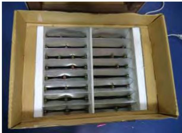
圖 22：「鋁片傾斜之漏斗構造」，當空氣通過時能達到加壓的效果
