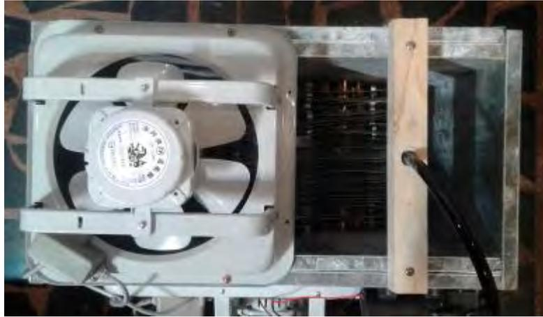
圖 47：降溫機俯視圖及「水氣蒸發抽出風扇」
