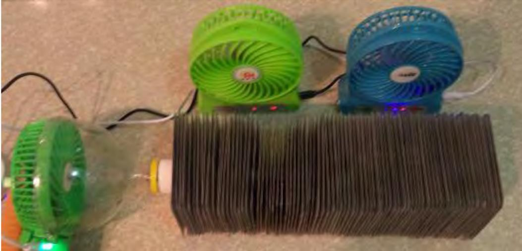
圖 41 「改變霧面鋁片間距」的散熱裝置
