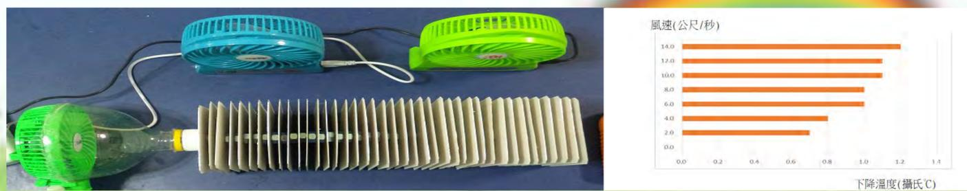
實驗四：探討「鋁片壓成皺褶狀並噴水」，增加鋁片表面積之蒸發降溫效果
