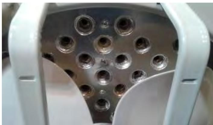
圖 45：機體外殼漏斗型空氣加壓入口
