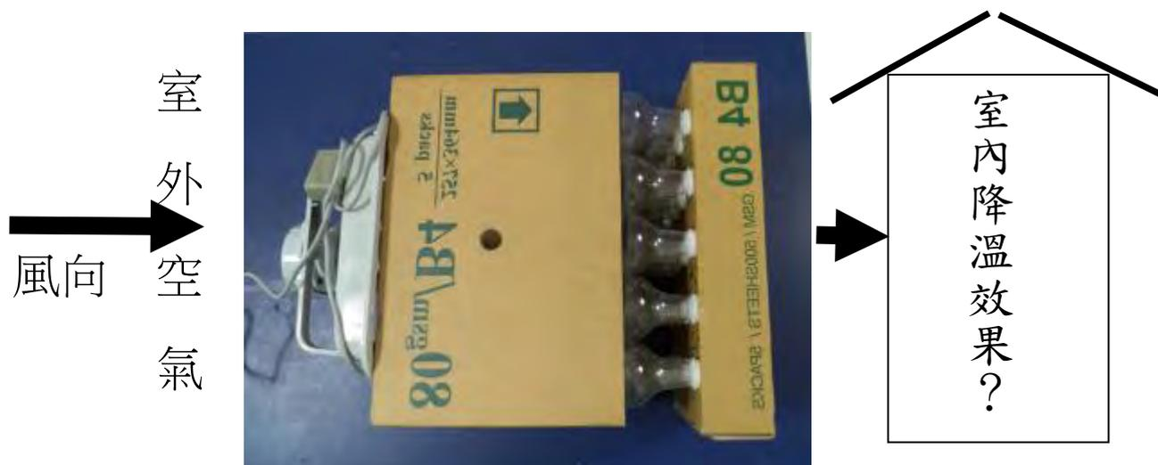
圖 19：「風從室外吹入屋內」之窮人冷氣模擬實驗
