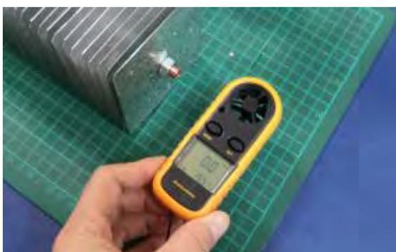
圖 29：電子風力溫度計
