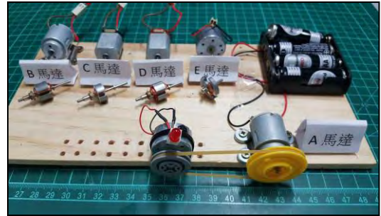
圖 1 測試不同馬達的發電情形
