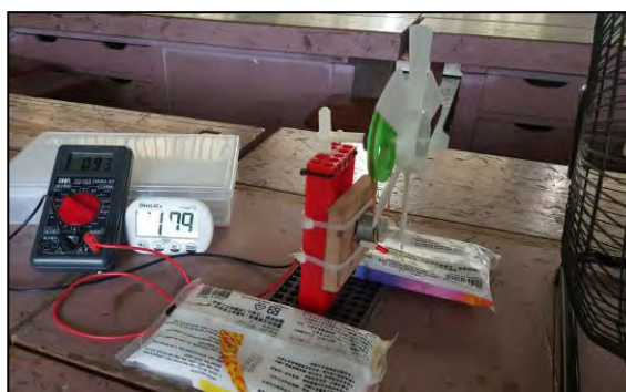
圖 10 LED 熄滅時超級電容的電壓
