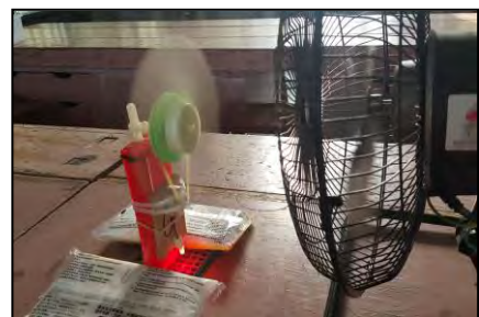
圖 5 測試風力發電情形
