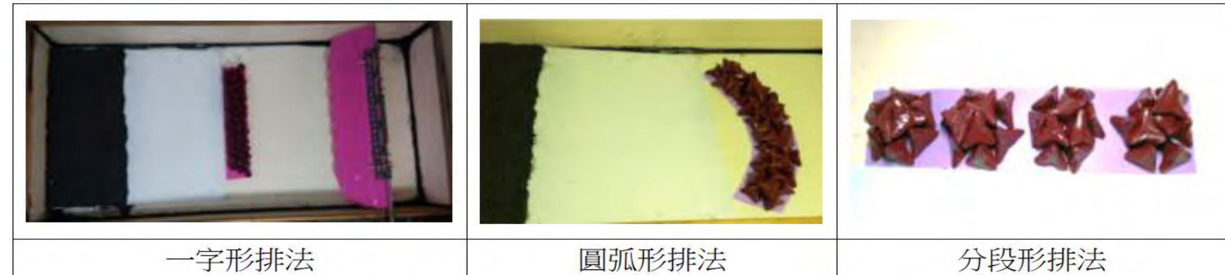
圖5 不同排法離岸堤解說圖
