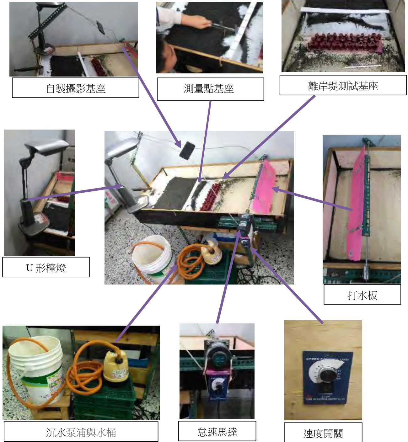
圖 3 波浪測試實驗裝置說明圖
