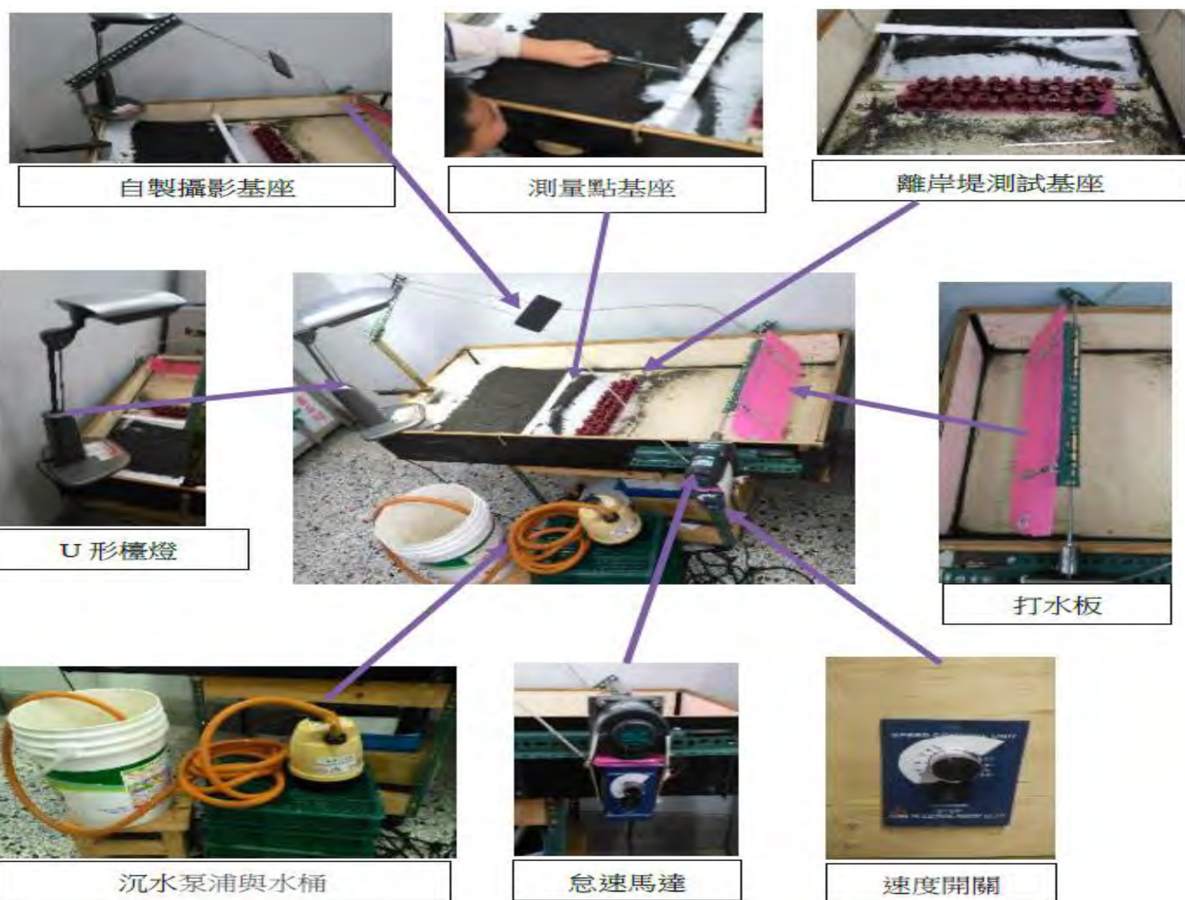
圖1 測試實驗裝置說明圖
