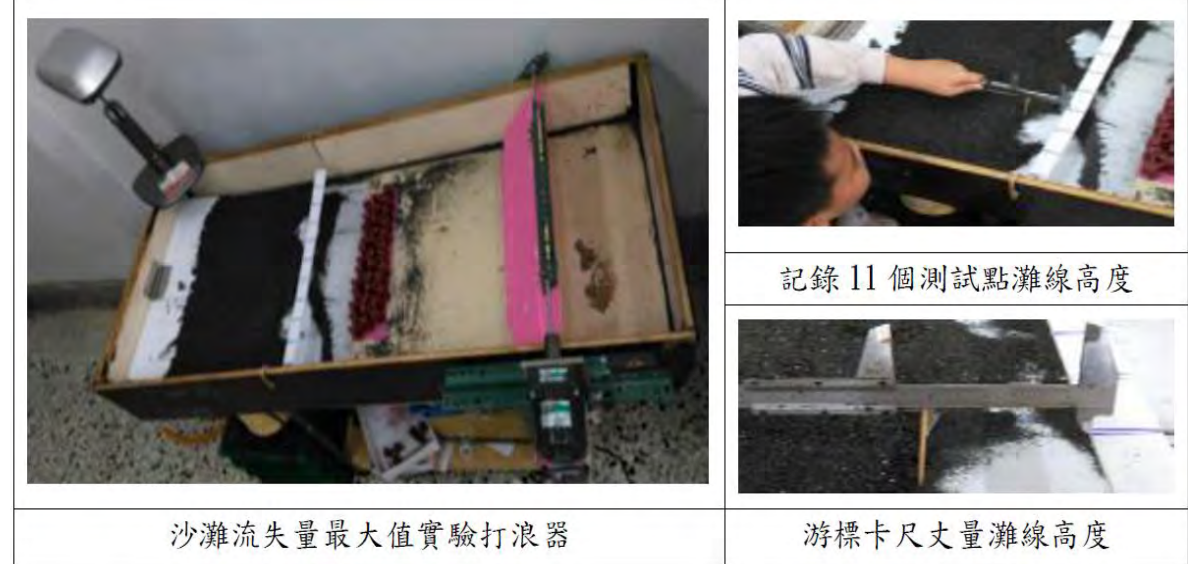
圖10 沙灘流失量最大值實驗解說圖
