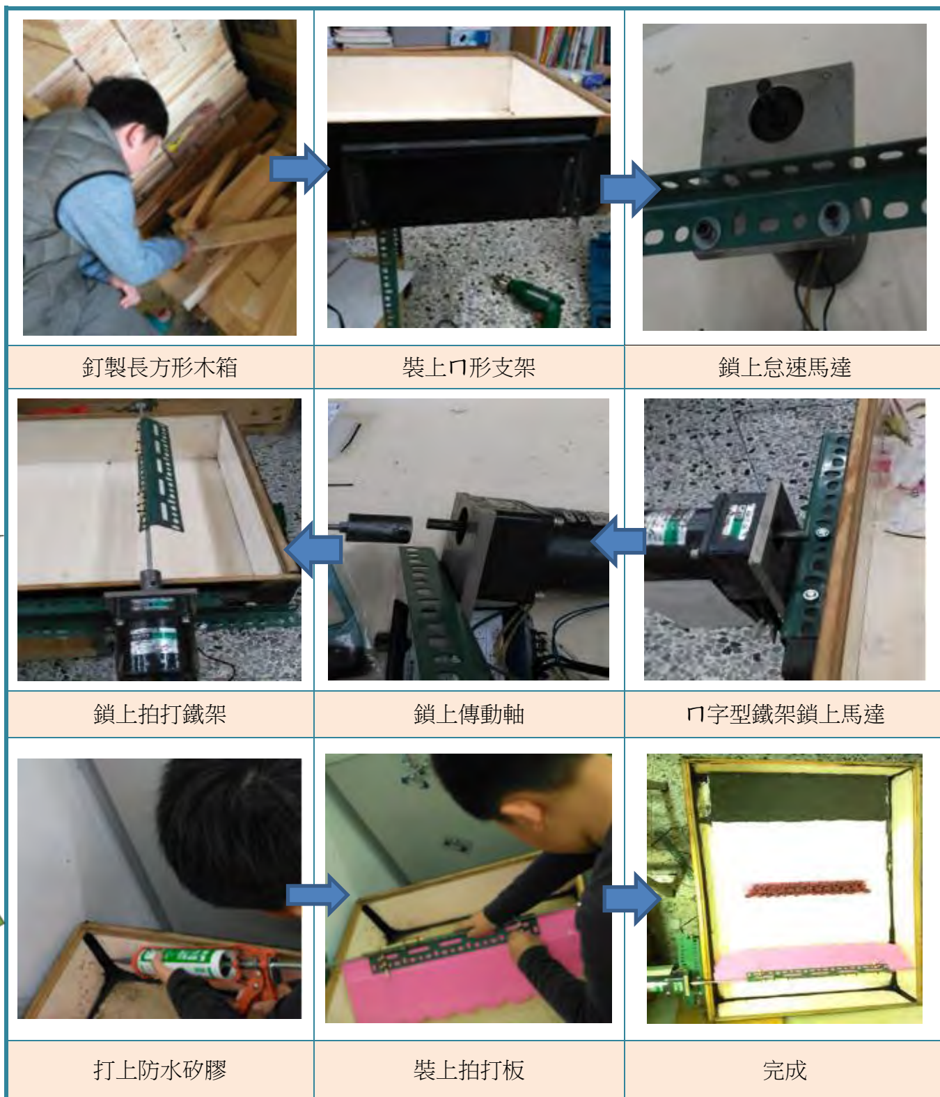
圖 2 自製海浪模擬器流程圖
