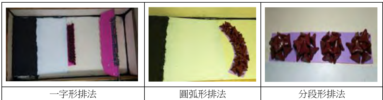
圖 8 不同排法離岸堤解說圖
