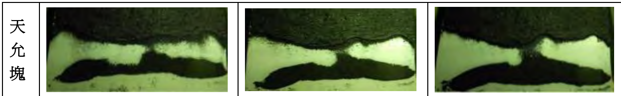
圖 18 圓弧形排法，不同時間沙灘流失量的變化實況
