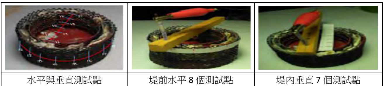
圖 15 圓形蚵殼人工礁堤前水平與堤內垂直測試點解說圖
