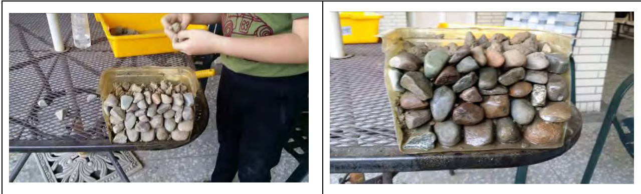
圖 6-11、圖 6-12、圖 6-13、圖 6-14:試驗大顆礫岩排列成擋土牆，測試其水沖蝕後情形。
