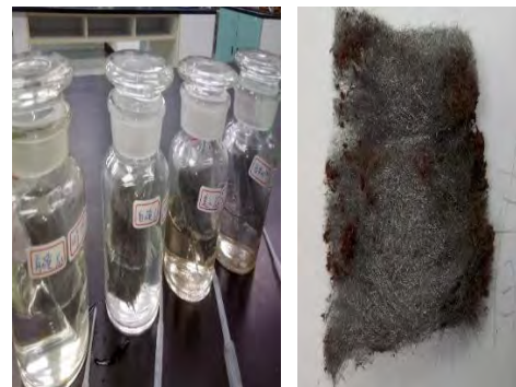
照片 32、溫泉蒸過的鋼絲絨生鏽情形
