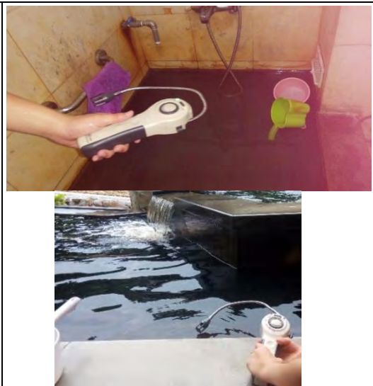
照片 13、利用可燃氣體檢測器測量溫泉的硫化氫
