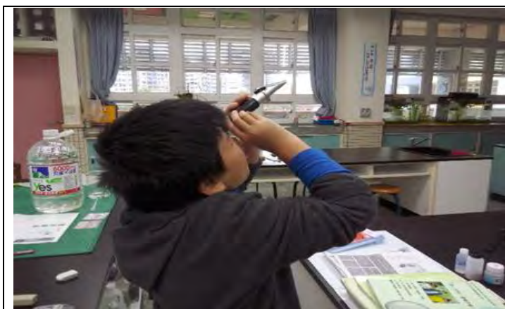
照片 20、利用鹽度計測量溫泉的鹽度(S)
