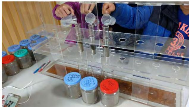
圖5.2.2 滲水實驗倒入50cc水進入試管中
