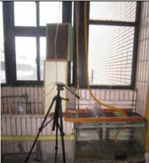
◎ 海浪沖擊測試(計算時間與水濺出狀況)
