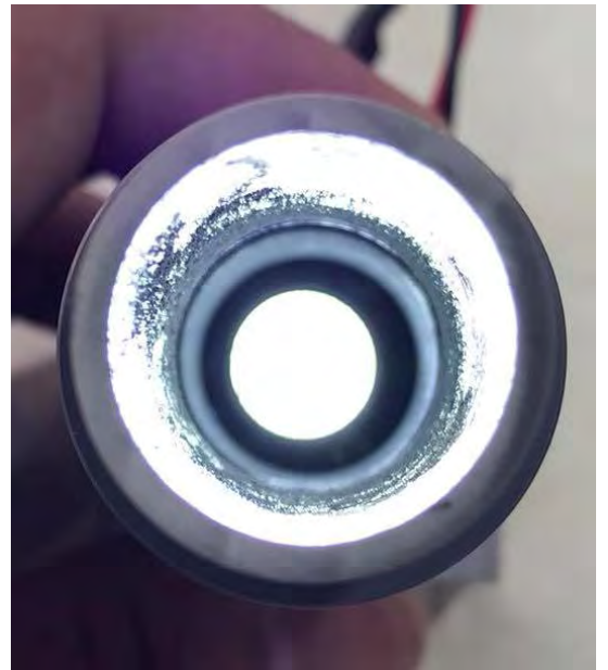
圖四、自製水管分光光度計第二代 內部構造，led 紫外光光源。
