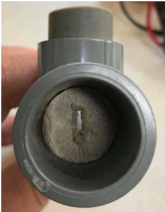
圖四、自製水管分光光度計第二代 內部構造，2mm 狹縫光柵。
