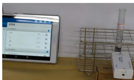
圖十五 利用光譜檢測儀測加入優碘前後的顏色變化
