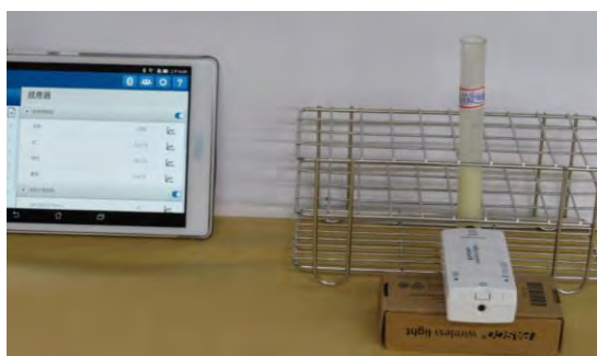
圖十五 利用光譜檢測儀測加入優碘前後的顏色變化
