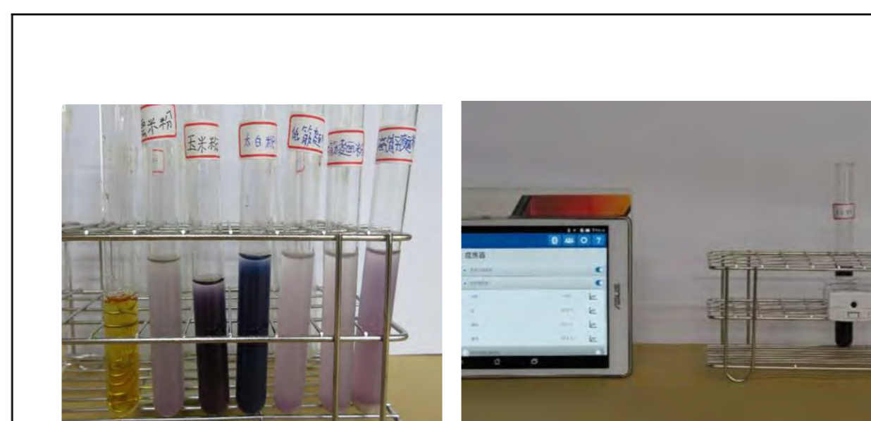
圖八 澱粉水溶液加入優碘後再利用光譜檢測儀測量
