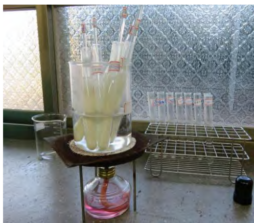
圖十四 六種澱粉水後再隔水加熱的情形
