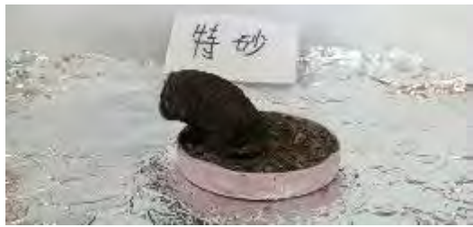
照片四十八、特級砂糖混合物燃燒後情形
