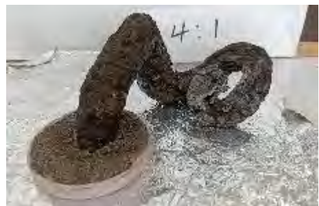
照片三十九、(混合物 D)糖:小蘇打=4:1 燃燒後情形
