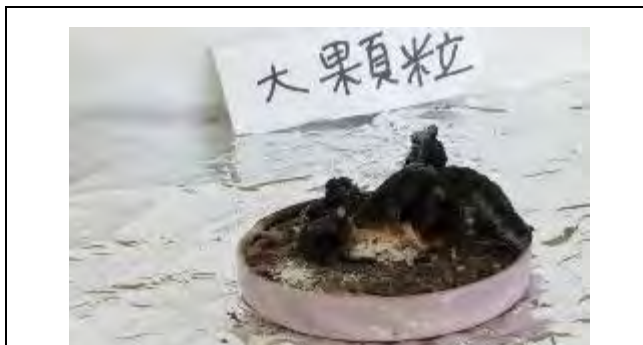
照片四十三、粗顆粒冰糖混合物燃燒後情形
