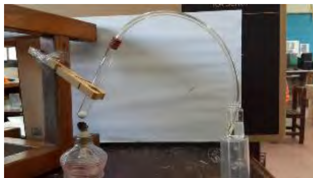
照片二十一、澄清石灰水檢驗 CO 2 裝置
