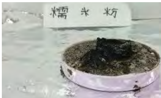
照片五十四、糯米粉混合物燃燒後情形
