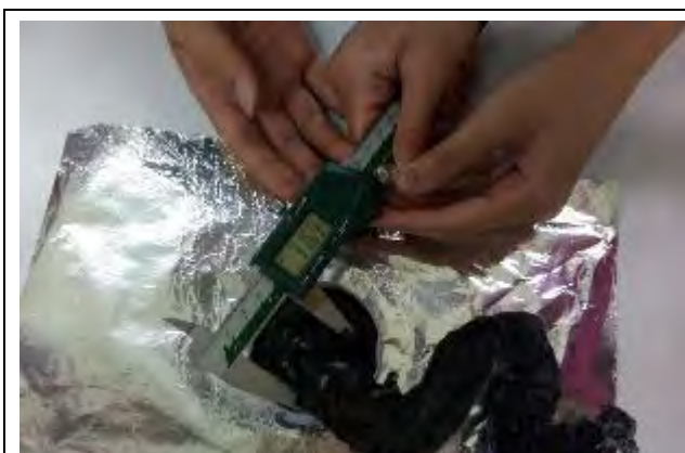
照片七、游標卡尺量黑糖蛇寬度
