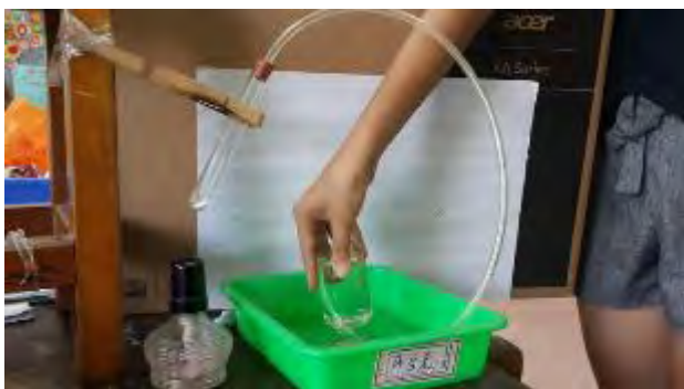
照片二十、排水集氣裝置
