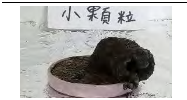
照片四十五、細顆粒冰糖混合物燃燒後情形
