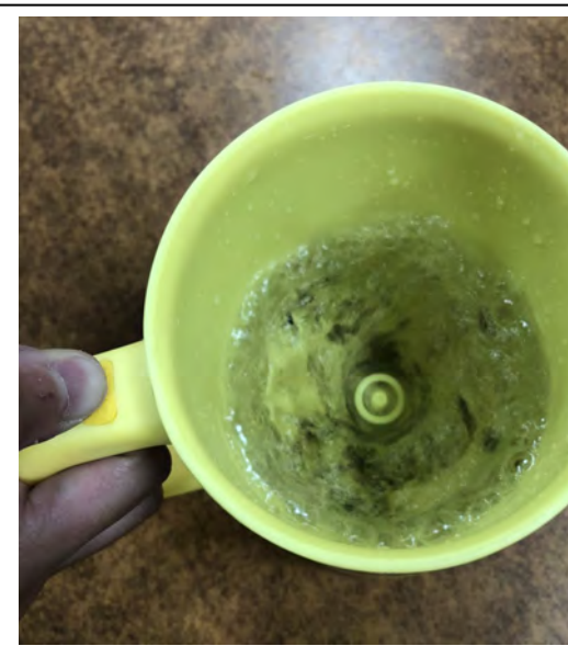
圖 1-4：用攪拌杯攪拌米和水，以取代用手洗米可能造成人為誤差。
