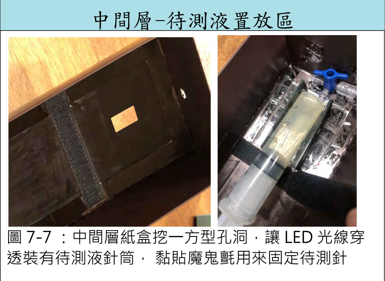
圖 7-7：中間層紙盒挖一方形孔洞，讓 LED 光線穿透裝有待測液針筒，黏貼魔鬼氈用來固定待測針
