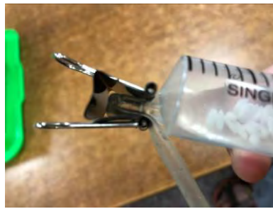
圖 1-6：在塑膠針筒前端套上塑膠軟管，將軟管反折以長尾夾固定，使塑膠針筒形成一個密閉的實驗空間。
