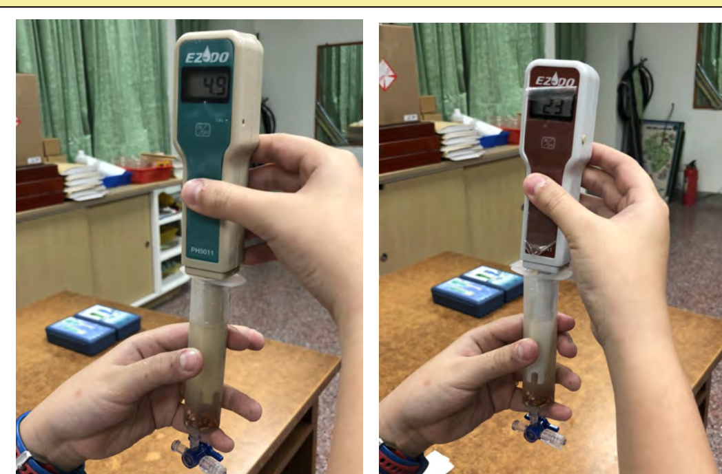
圖 2-2：用 PH 計及氧化還原電位計測淘米水。
