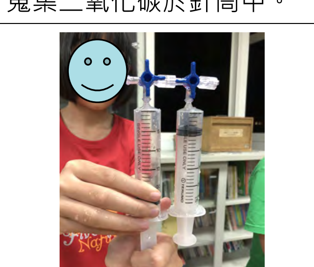
圖 7-14：製備出不同濃度的二氧化碳實驗用針筒。
