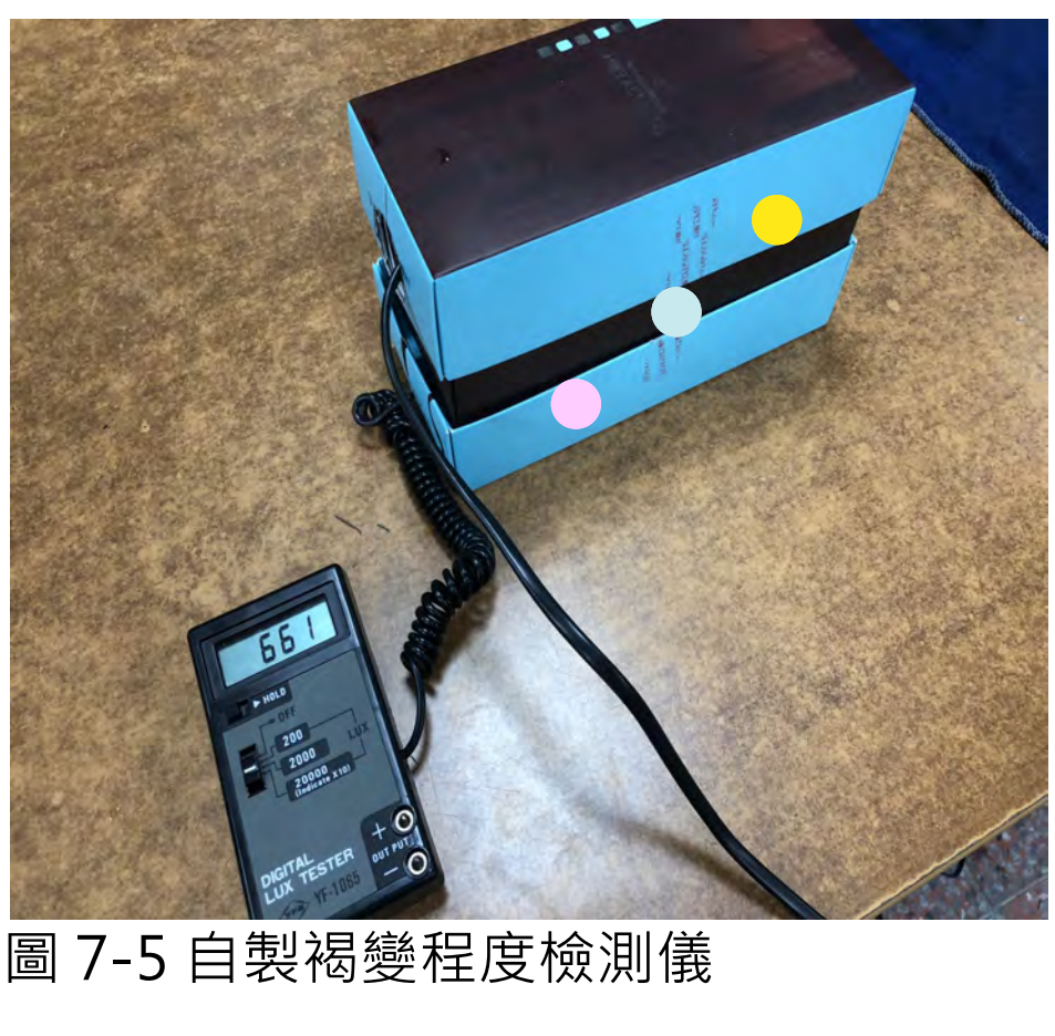
圖 7-5 自製褐變程度檢測儀
