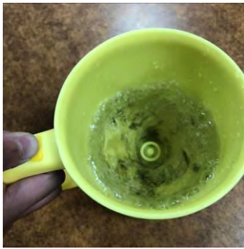
圖 1-5：用攪拌杯攪拌米和水，取代用手洗米可能造成的人為誤差。
