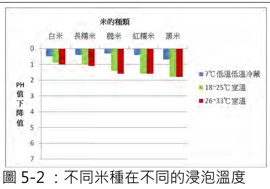
圖 5-2：不同米種在不同的浸泡溫度下，其 PH 下降值之比較圖
