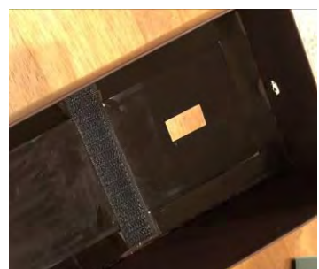
←圖 7-7： 中間層紙盒挖 一方型孔洞， 讓 LED 光線穿 透裝有待測液 的針筒。
