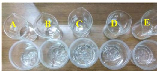
圖 3 5%PVA 水溶液 10 ml，各加入 5%硼砂水溶液 A = 1 ml，B = 5 ml，C = 10 ml，D = 20 ml，E = 30 ml。對應的下排為該杯的交聯物質。
