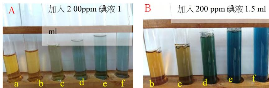
圖 7 0.2% PVA 溶液 3 ml 溶液，A 圖為加入 200 ppm 碘液 1 ml，B 圖為加入 200 ppm 碘液 1.5 ml，加入 5% 硼酸水溶液分別為 a = 0 ml, b = 1 ml, c = 2 ml, d = 3 ml, e = 4 ml, f = 5 ml。
