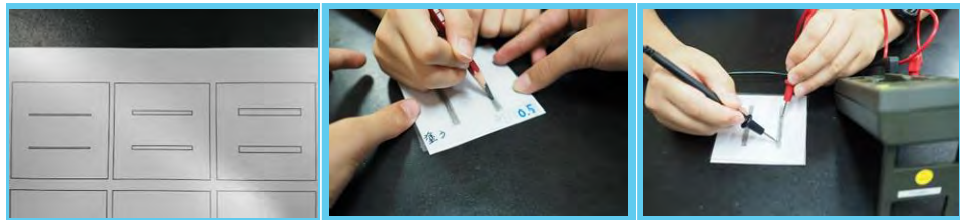
1. 製作模板，以產生固定條件線條。 2. 以鉛筆畫下長1、2、3cm和寬0.1、0.3和0.5cm的線條。 3. 測量鉛筆線的電阻。
