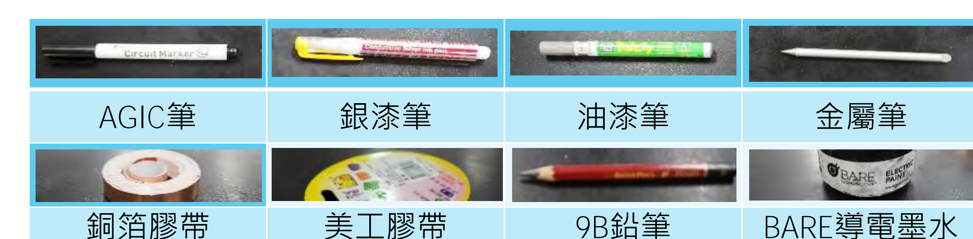
1. 使用市售BARE導電墨水塗在八種紙上。 2. 計算導電材質在不同紙上的乾燥時間。 3. 測量導電材質在各種紙的電阻及照度。
