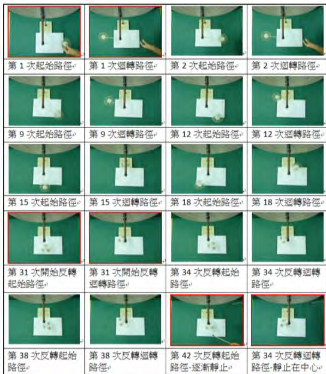
圖 4-1-3 指尖陀螺旋轉擺動路徑分析
