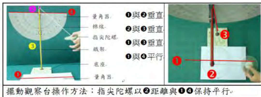
圖 4-1-1 擺動觀察台及操作方法
