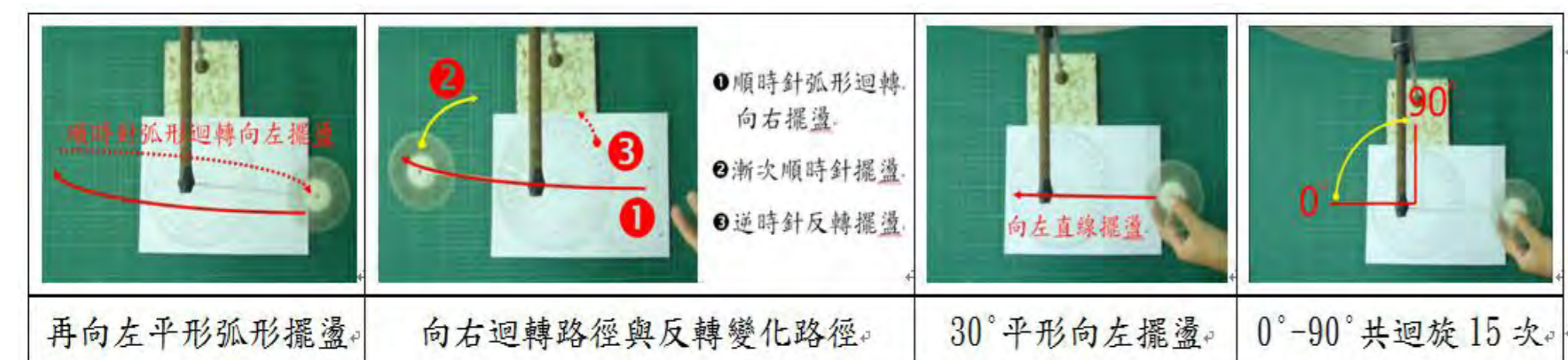
圖4-1-2 指尖陀螺旋轉擺動路徑
