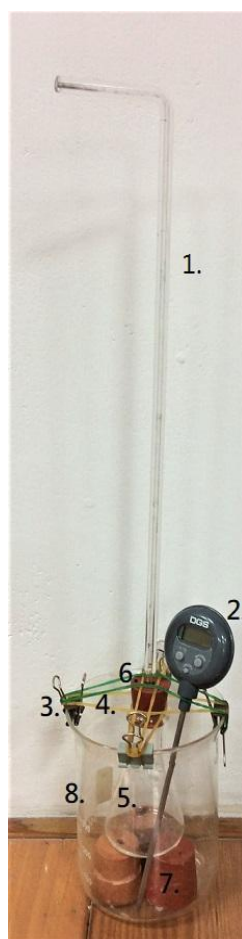
圖二 氣體體積與溫度變化紀錄裝置與器材圖
