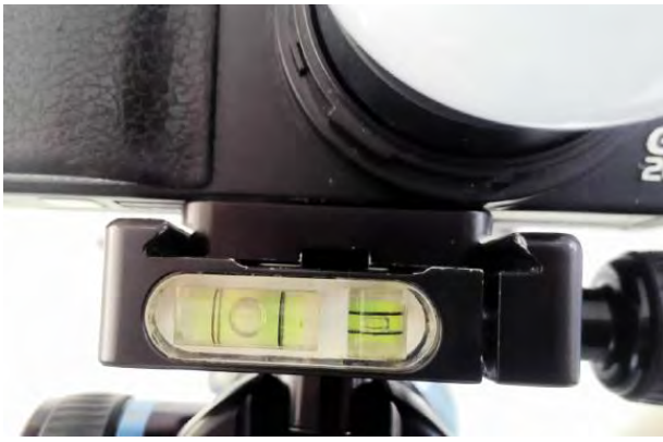
圖 4-2-1 以水平儀校準鏡頭垂直
