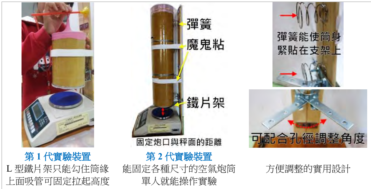
圖 9 固定空氣炮與秤的距離
