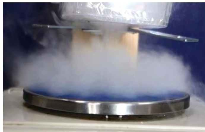
圖 10 氣流衝出炮孔打在秤面上
