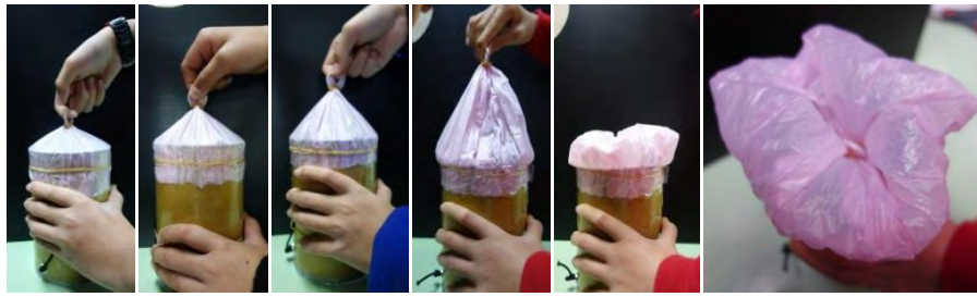
圖 18 拉起高度不同，12 cm 的太長，彈回時會卡在筒口
