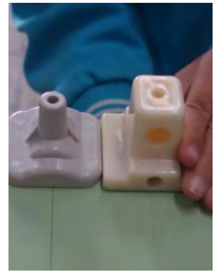
固定測量飄行距離 的滑輪實驗支架
