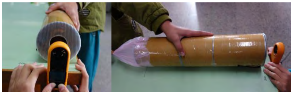
圖 11 風速計測量衝出氣流的速度
