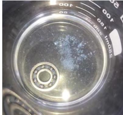
圖 5-2：清洗軸承後的殘餘物質圖
