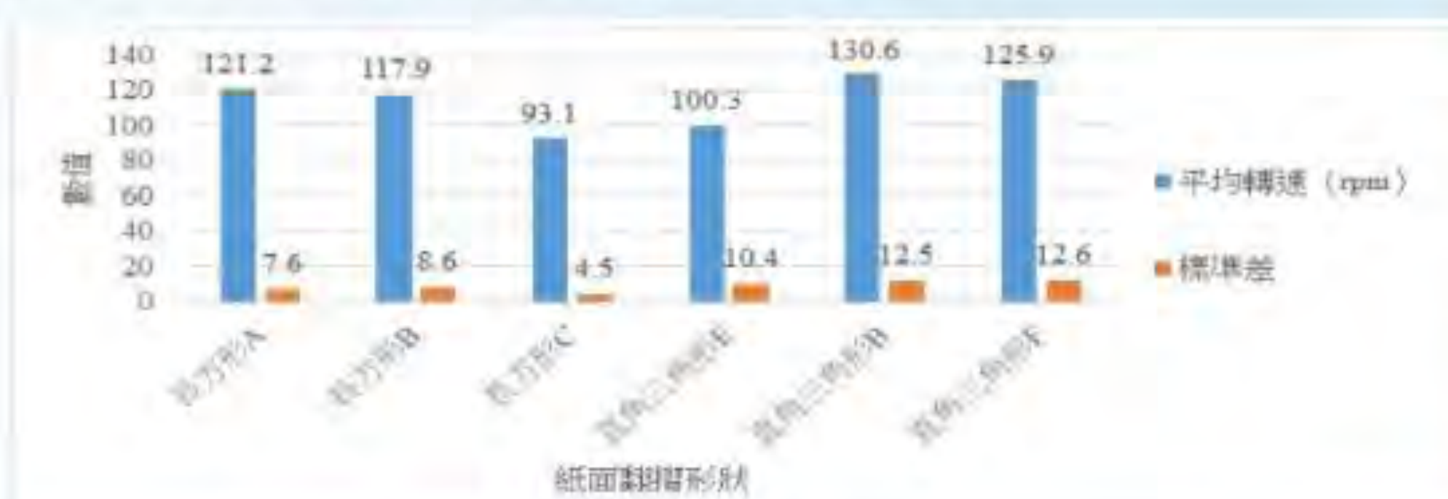
圖27.相同底長不同高的翻摺紙面對風力環旋轉的影響
