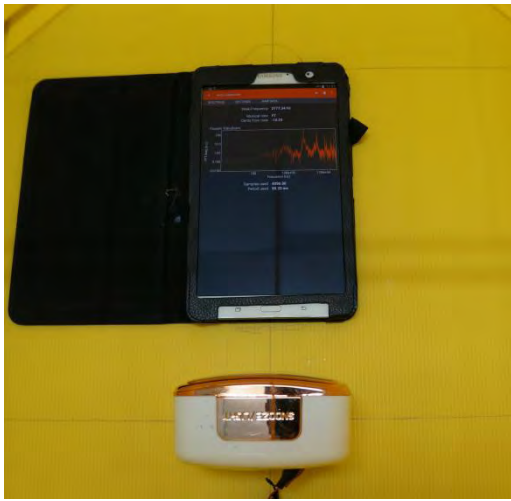
圖 7.1 Samsung 平板操作 APP 軟體 (PHYPHOX - audio spectrum) 量測實驗音源聲譜的情況
