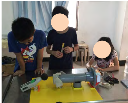
圖 5.14 窗簾隔音測試情形(傳聲筒測試平台)
