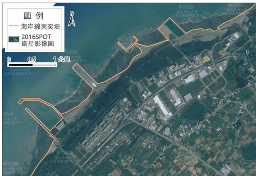
圖 10：連續突堤間的海積作用
