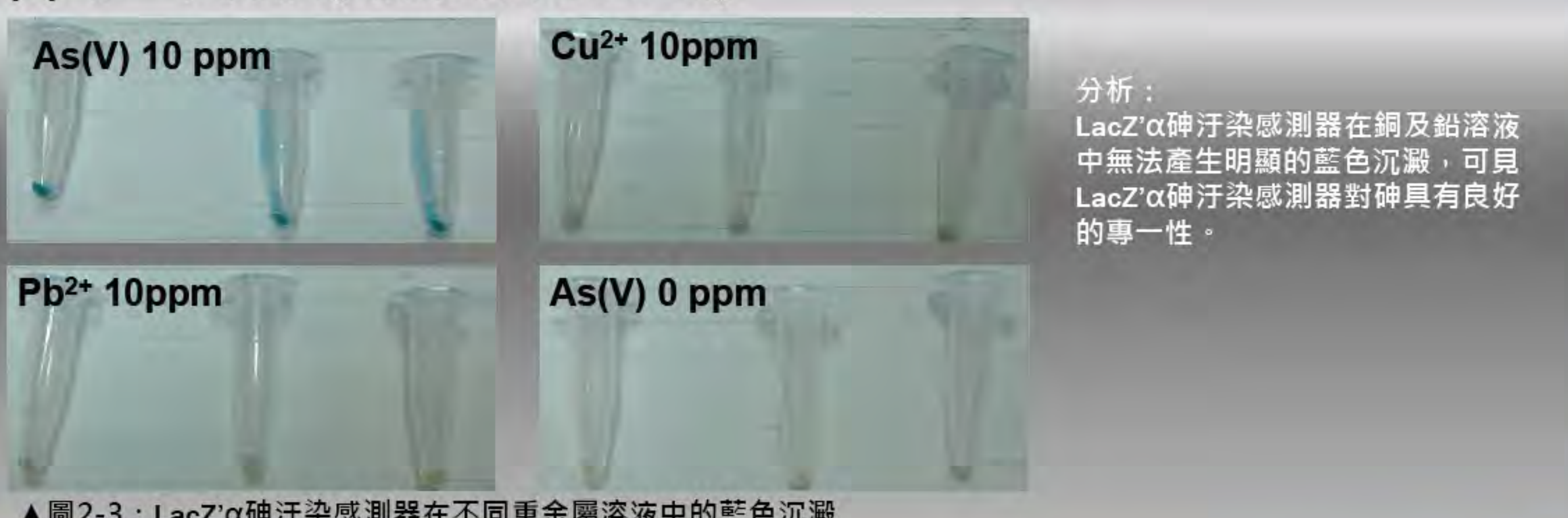
▲圖2-3：LacZ'α砷汙染感測器在不同重金屬溶液中的藍色沉澱
