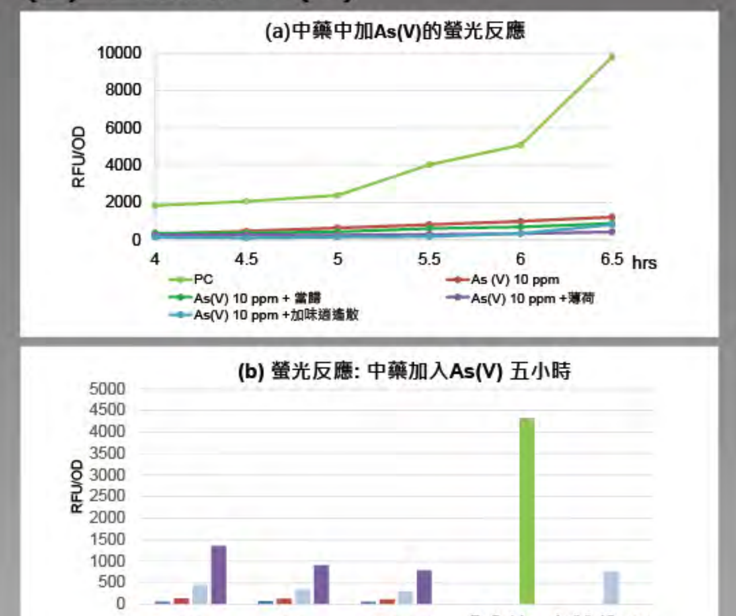
▲圖4-3：GFP生物感測器在中藥加As(V)的螢光密度 分析：在中藥中加砷，螢光密度隨As(V)濃度增加。
