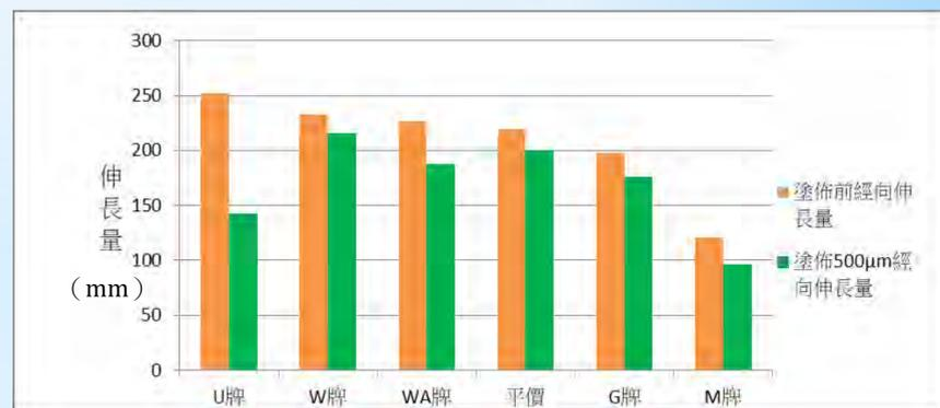
塗佈前與塗佈500μm 15wt%薄膜經向拉伸比較
