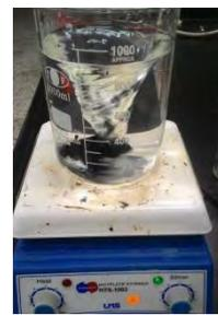
圖十二：磁石攪拌器
