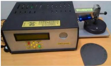
圖七：Alambeta設備儀器
