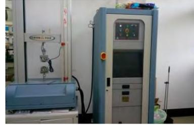
圖六：標準型微電腦萬能材料試驗機—CY-6012
