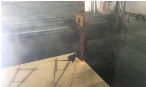
圖4-15 使用雷雕機將模型割下
