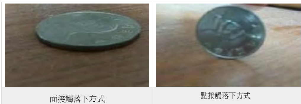
圖十二、樣品撞擊方式與頻譜分析實驗
