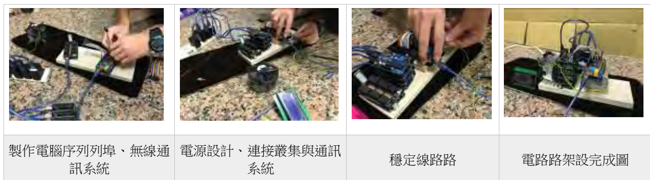
圖十七、音頻測試機台製作過程
