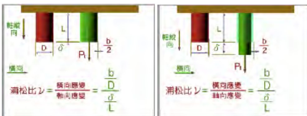
圖五、浦松比示意圖：當一可變形物體受軸向拉力( P_t )，不只在軸向會伸長，其軸向也會收縮;受壓縮力時則反之。
