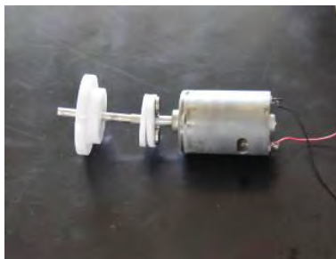
磁力非接觸方式帶動連桿
