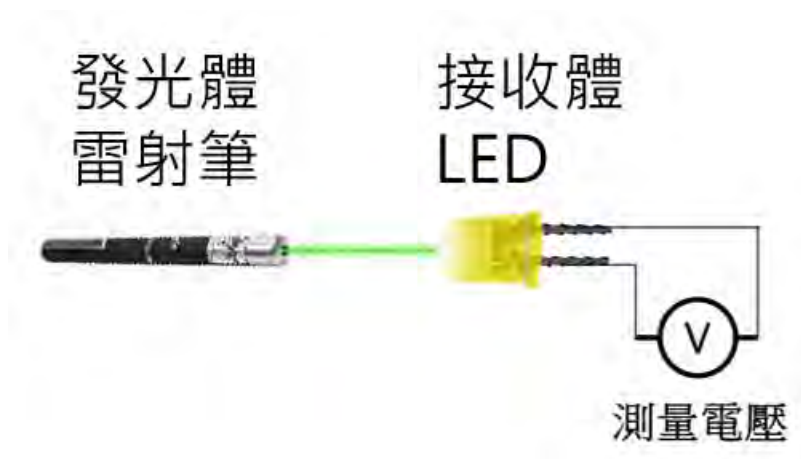
圖 8-雷射筆照 LED 示意圖
