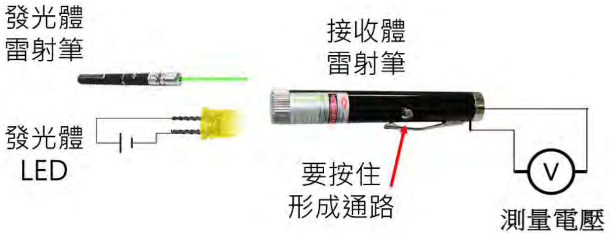
圖 11-雷射筆當做接收體示意圖
