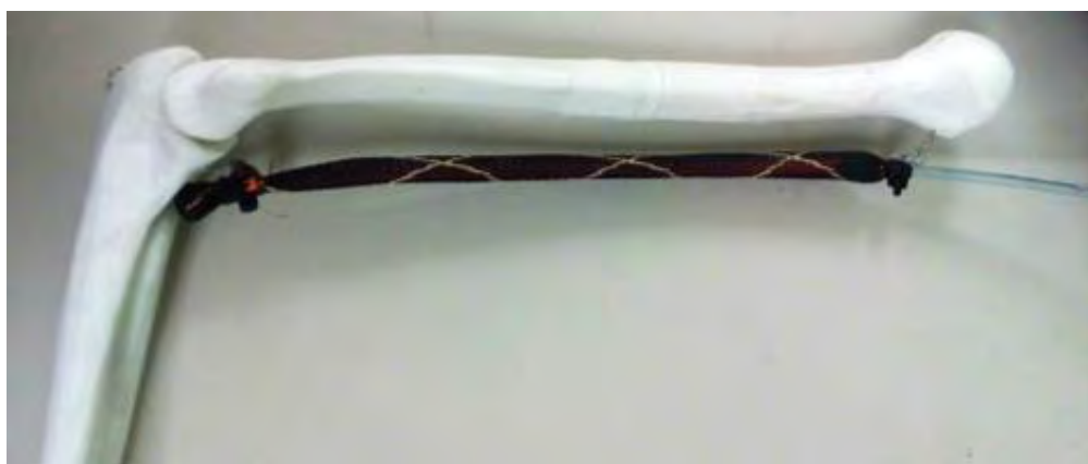
圖 8 氣動肌肉缸固定肌肉於骨骼的情況
