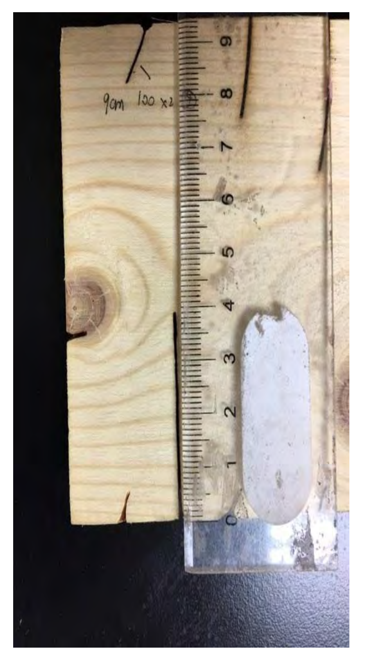
(四) 測量待切割物被切割之深度
