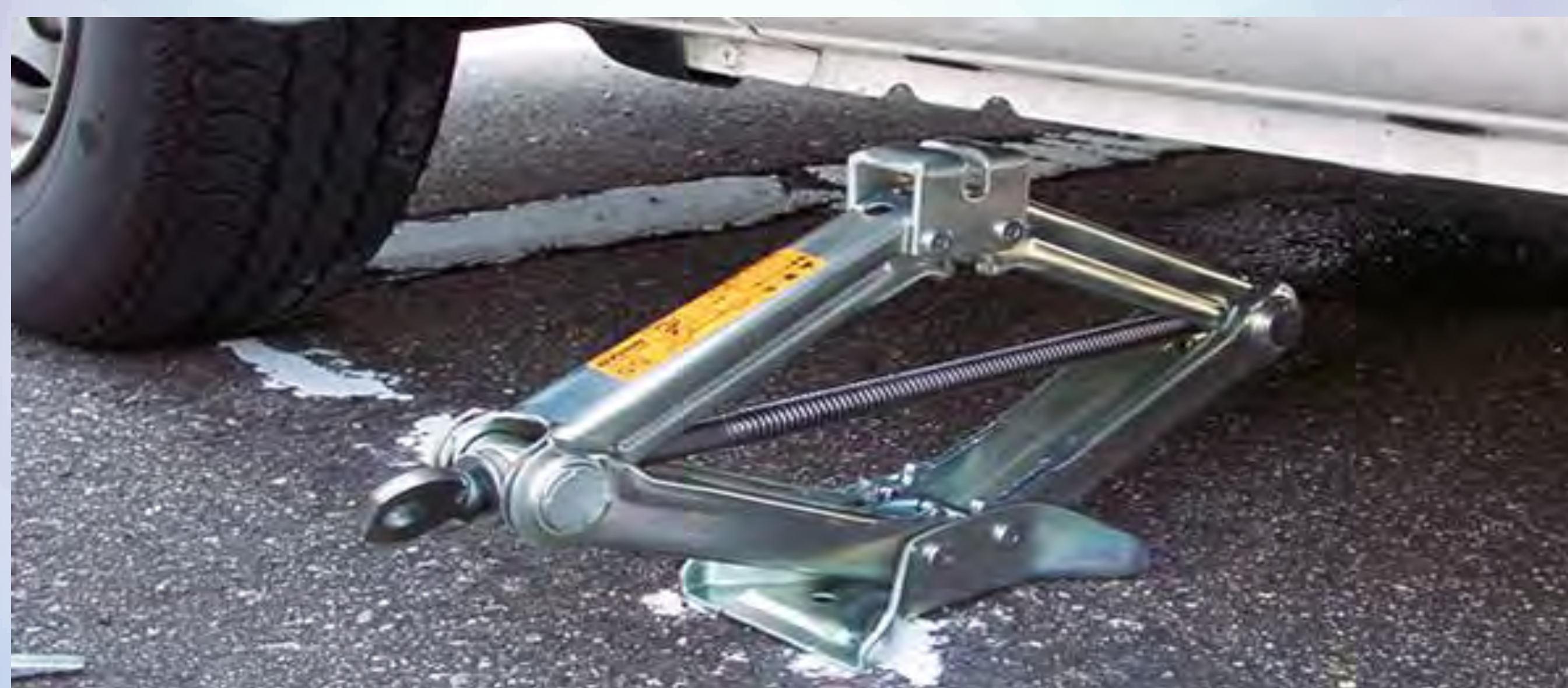
圖1 目前廣泛使用的汽車隨車千斤頂。
