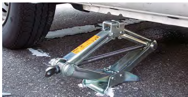
圖 1 目前廣泛使用的汽車隨車千斤頂。
